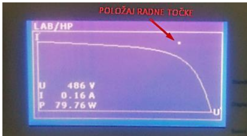
Slika 3.7. Položaj radne točke izvan karakteristike[3]
