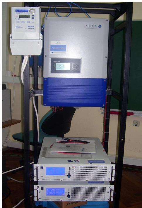
**Slika 2.1.** Emulator fotonaponskog sustava
