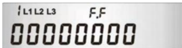
Slika 2.6. Pokaznik za utvrđivanje ispravnosti spoja brojila
