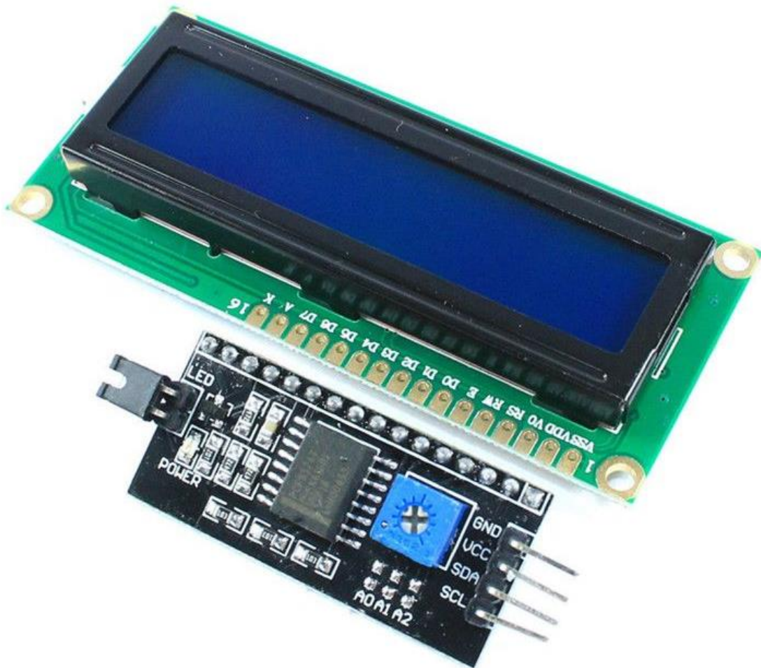
Slika 3.5. Prikaz 16x2 LCD ekrana s Hitachi HD44780 kontrolerom i I2C sklopom[10].
