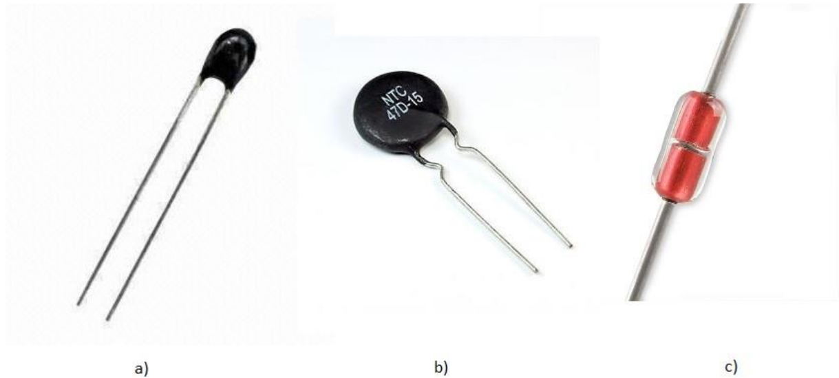
Slika 2.2. Osnovni tipovi NTC otpornika: a) kugličasti, b) disk, c) u staklenoj ovojnici.
