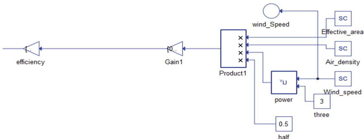
Sl. 3.3. Blokovi za izračun izlazne snage vjetroagregata
