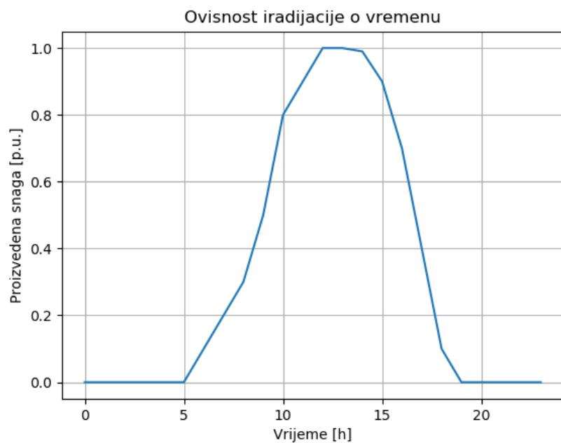
Slika 4.4. Ovisnost iradijacije (proizvodnje snage) o vremenu.
