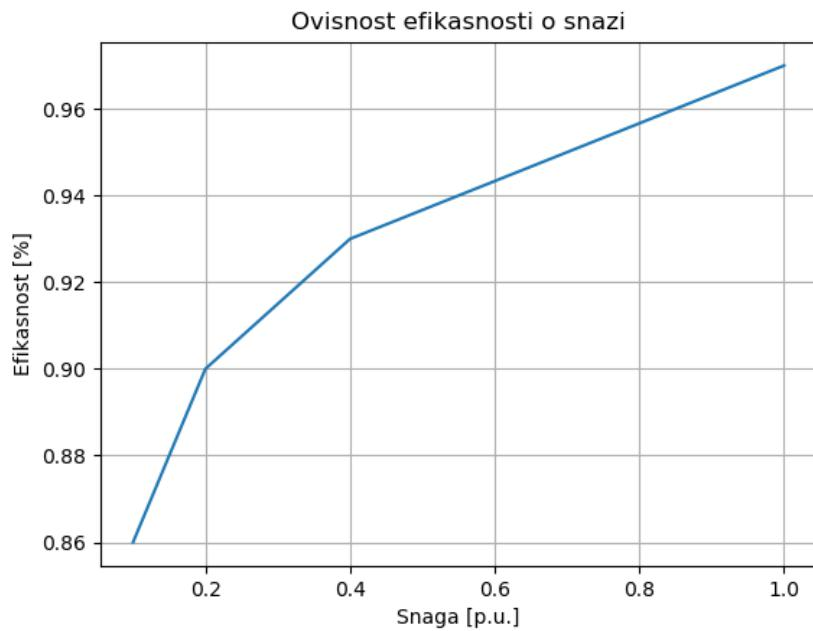
Slika 4.3. Ovisnost efikasnosti fotonaponskog sustava o proizvedenoj snazi.
