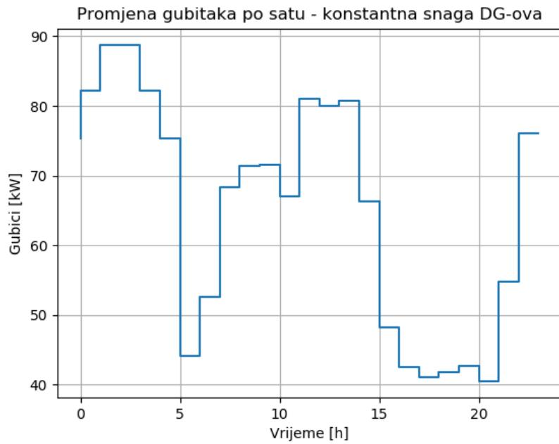
Slika 4.11. Promjena gubitaka po satu za konstantne snage upravljenih distribuiranih izvora.
