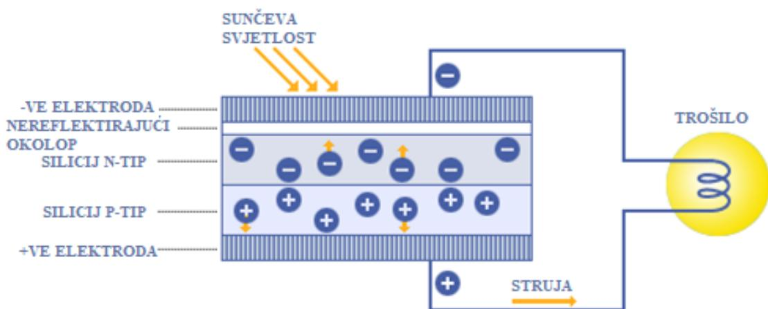
Slika 2.3. Princip rada fotonaponske čelije. [13]
