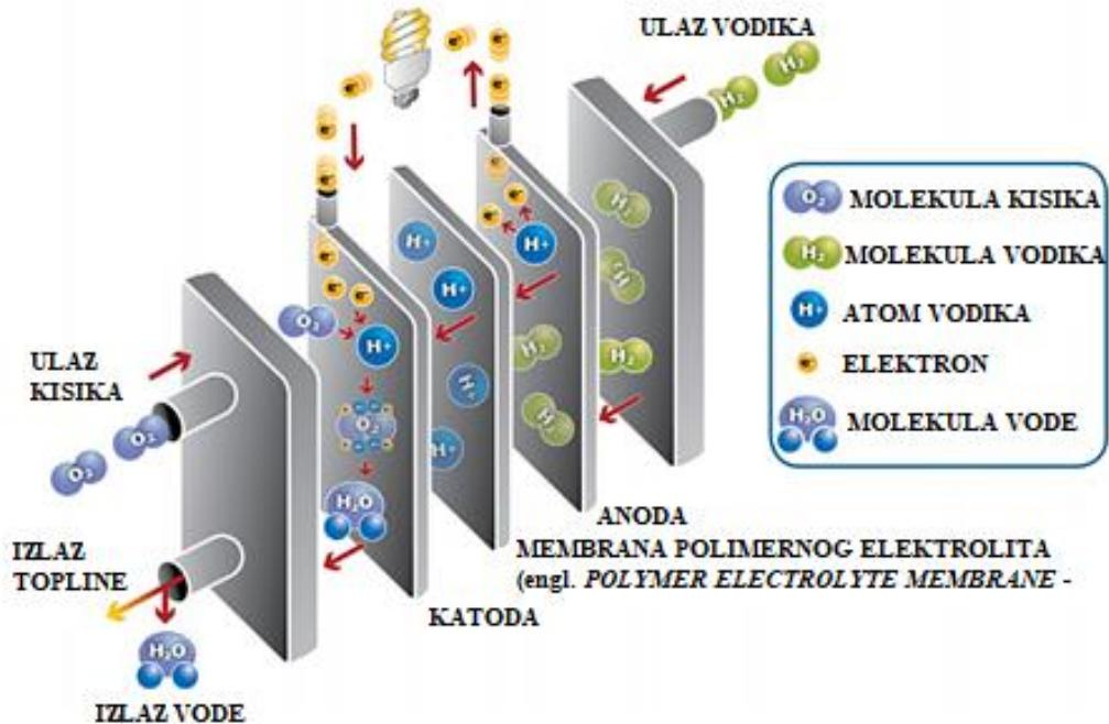
Slika 2.2. Princip rada gorivne ćelije. [12]
