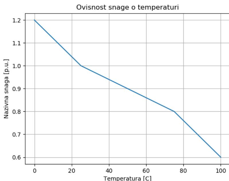
Slika 4.2. Ovisnost nazivne snage fotonaponskog sustava temperaturi čelije.
