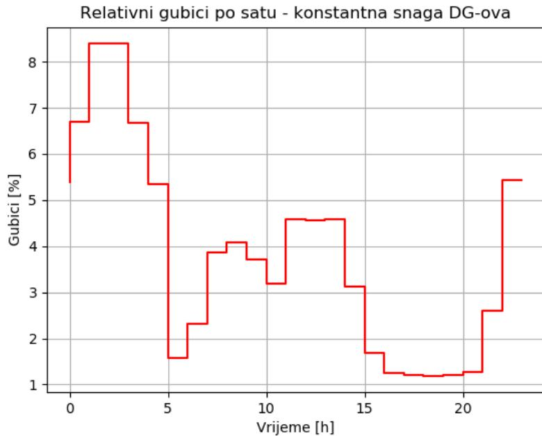
Slika 4.12. Relativni gubici po satu za konstantne snage upravljenih distribuiranih izvora.
