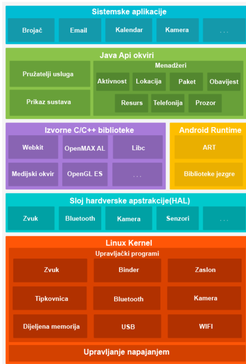
Slika 1.2. Android arhitektura (izvor: https://developer.android.com/guide/platform .)
