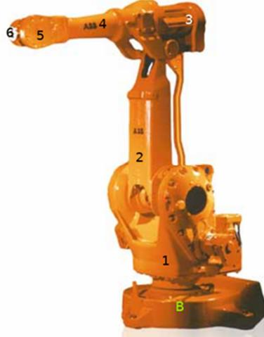
Slika 3.1 Korišten robotski manipulator sa označenim člancima
