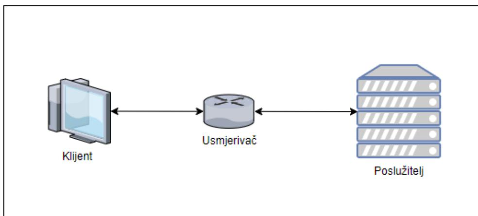
Slika 4.1. Mrežna struktura korištena pri testiranju algoritama
