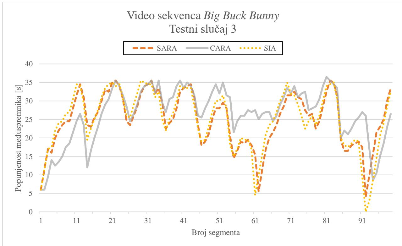
Slika 4.7. Promjena razine međuspremnika za treći testni slučaj
