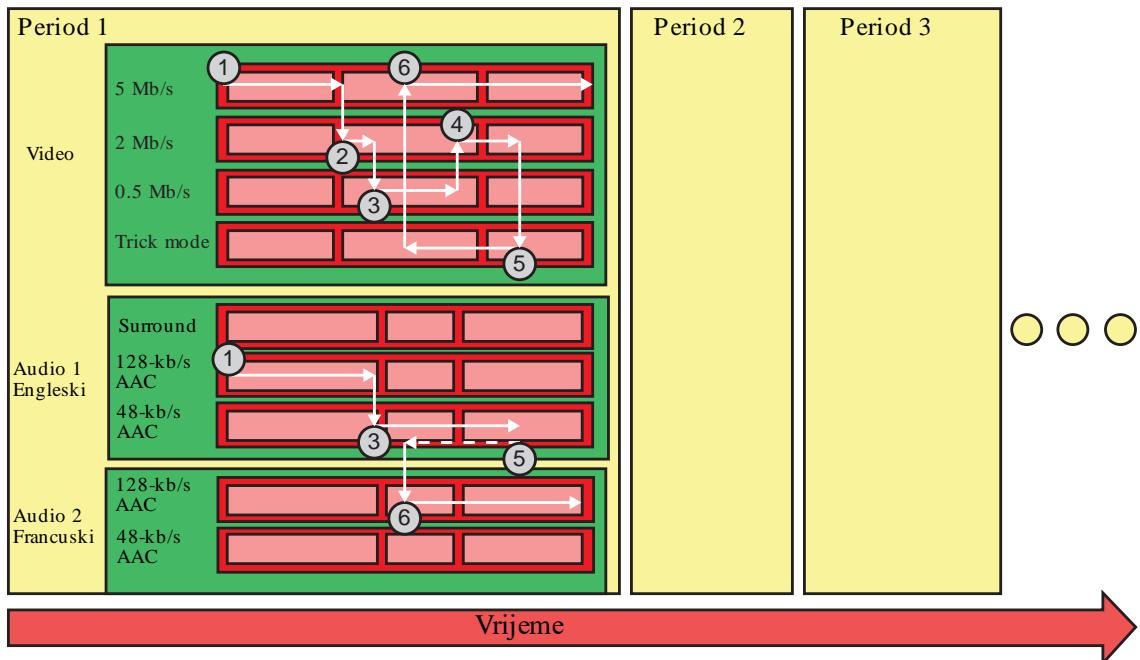
Sl 2.5 Primjer MPEG-DASH dinamičkog strujanja [3]
