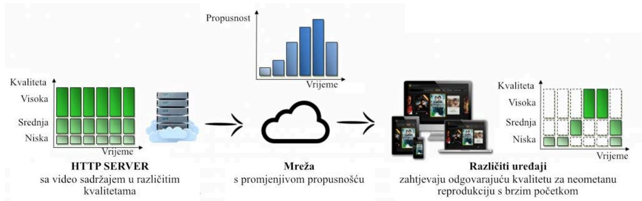
SI 2.2 Osnovni princip rada dinamičkog strujanja [2]
