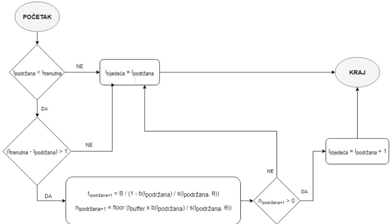
Sl 3.2. Dijagram toka QDASH adaptacijskog algoritma
