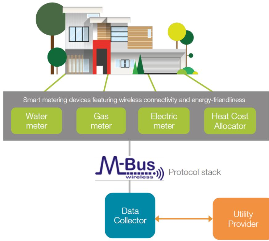
Slika 3.5. Arhitektura mjernog sustava koji sadrži WM-Bus [15]
