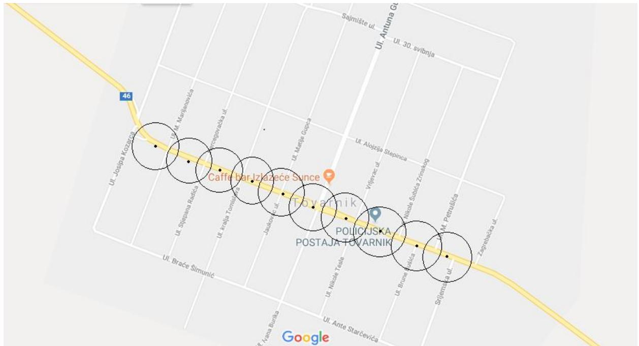
Slika 4.2. Realna udaljenost i broj koncentratora
