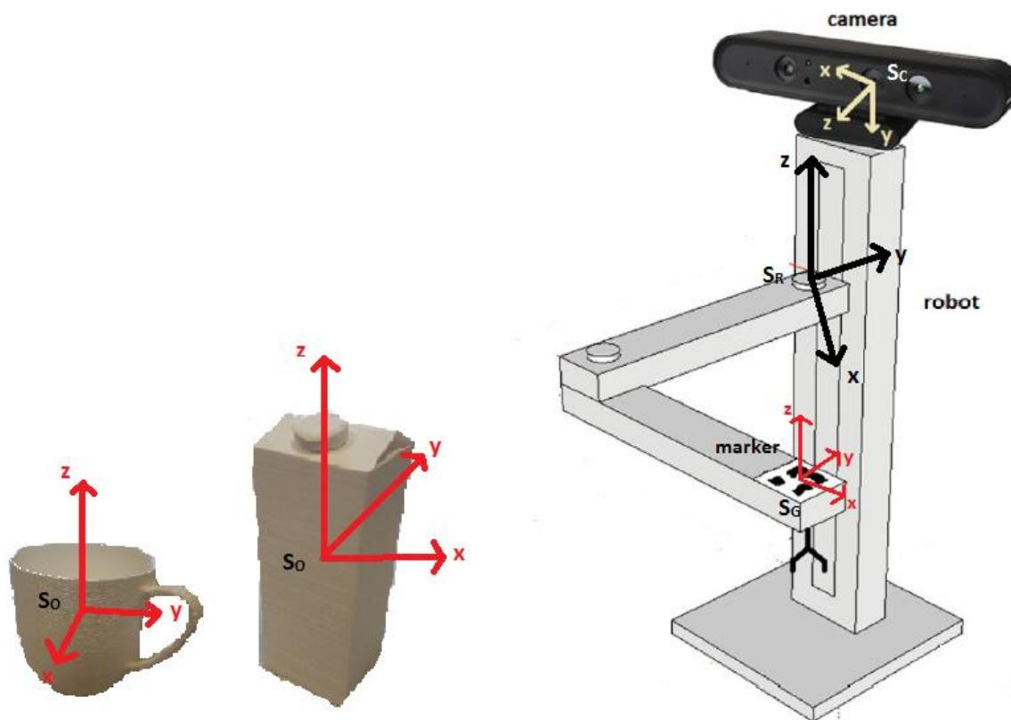
*Slika 2.1. Prikaz cijelokupnog sustava potrebnog za robotsku manipulaciju*
