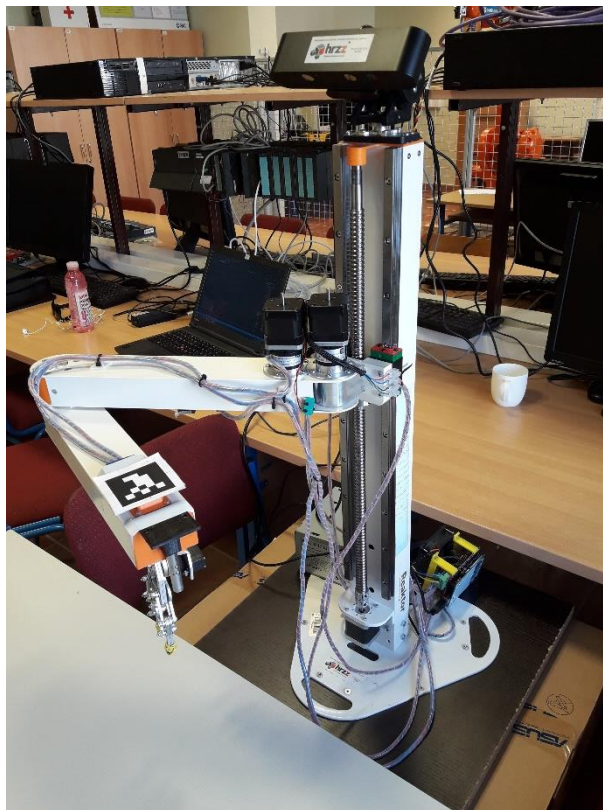
Slika 4.1. Robotski manipulator u SCARA konfiguraciji
