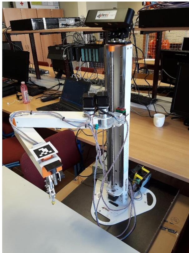
Slika 4.1. Robotski manipulator u SCARA konfiguraciji
