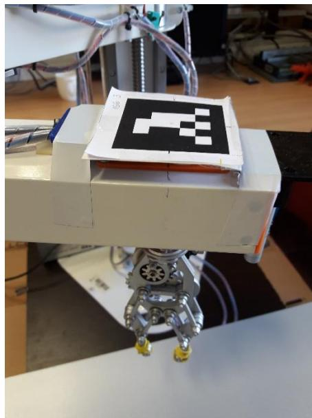
*Slika 2.7. Marker smješten iznad alata robotskog manipulatora*
