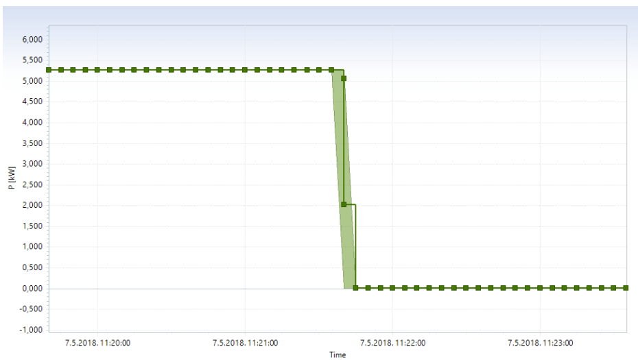
Slika 8.11. Prikaz mjerenja snage P u fazi L3
