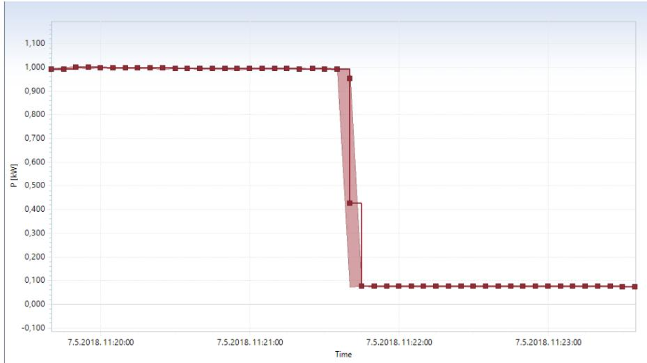
Slika 8.10. Prikaz mjerena snage  $P$  u fazi L2
