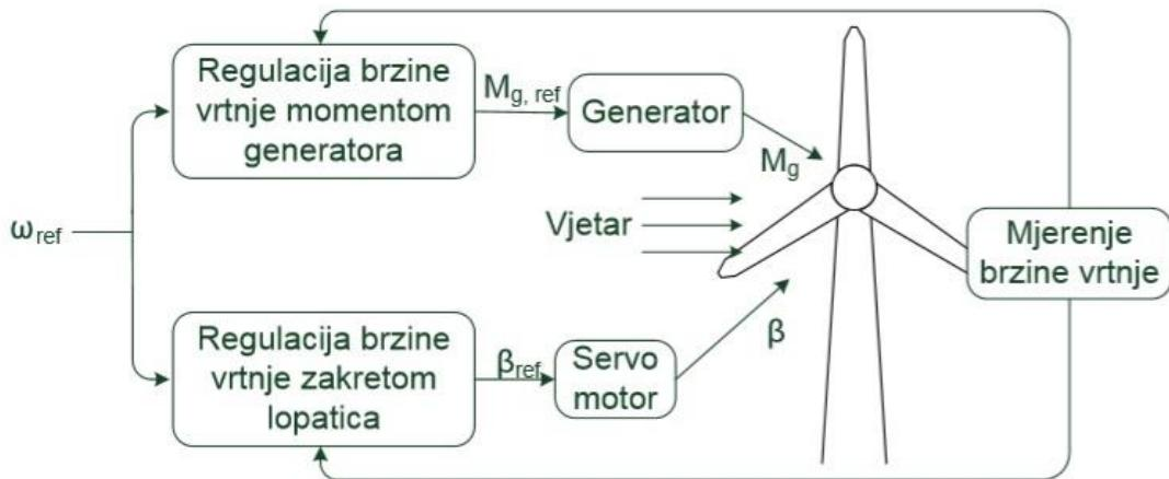
Slika broj 8.1. Načelna shema sustava upravljanja
