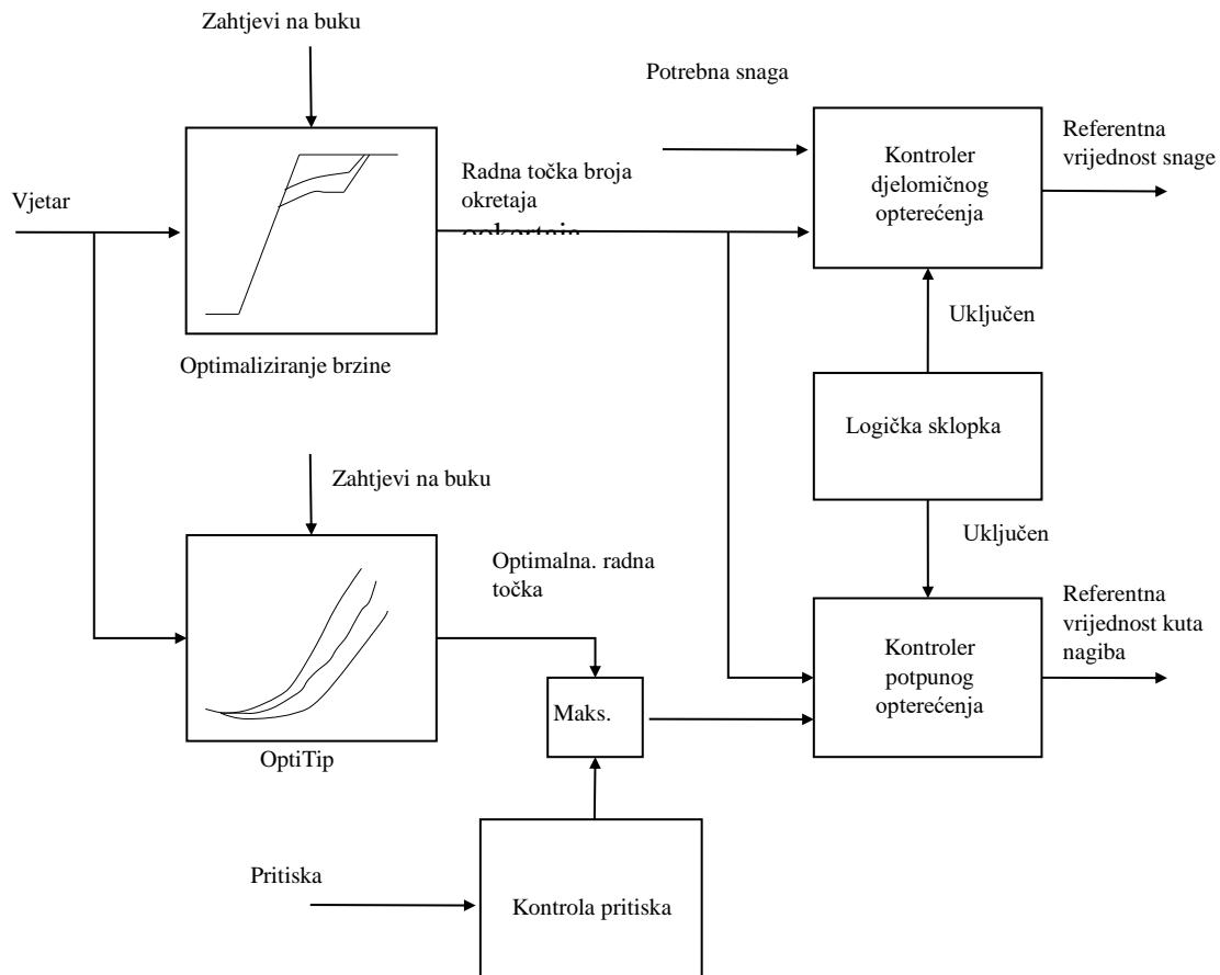
*Slika broj 10.1. Opća blok shema glavne kontrole i najvažnijih funkcija regulacije*
