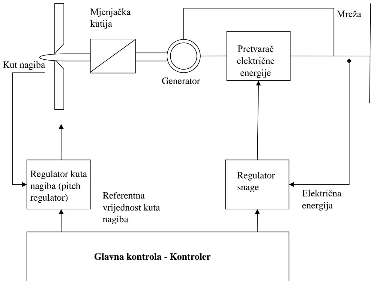
*Slika broj 9.1. Apstraktna shema VestasOptispeed kontrolnog sustava*
