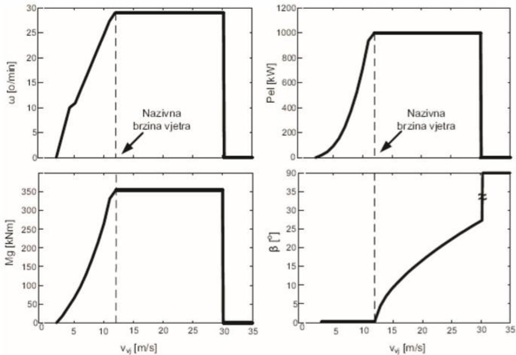
Slika broj 8.2 Statičke karakteristike vjetroagregata snage 1(MW)
