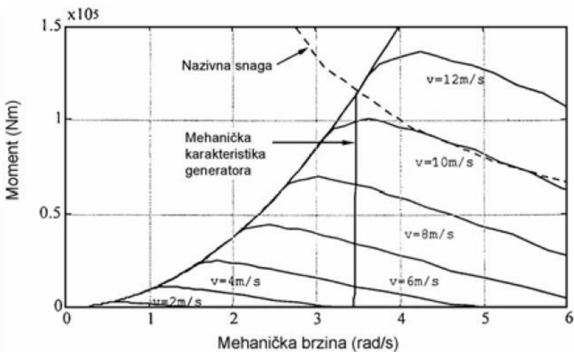
Slika broj 6.3. Karakteristika 400 kW vjetroturbine i asinkronog generatora – stalna brzina vrtnje –
