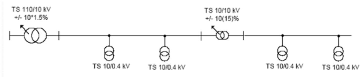
**Slika 2.14.** *Regulacija napona pomoću uzdužnog transformatora [4]*
