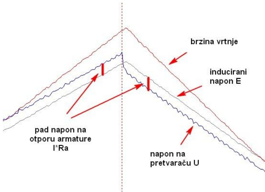
**Sl. 5.10:** Odnos induciranoj i armaturnoj napona pri prelazu iz I. u II. kvadrant
