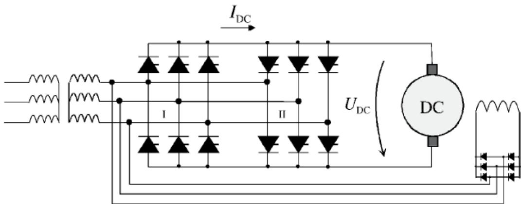
**Sl. 3.7:** Tiristorski usmjerivač u trofaznom antiparalelnom spoju
