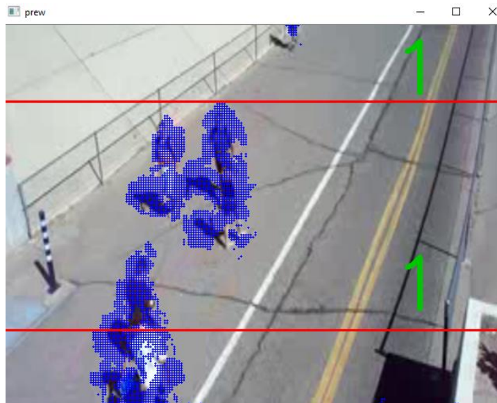
Sl.4.19. cv::calcOpticalFlowFarneback i video 4b rezultat
