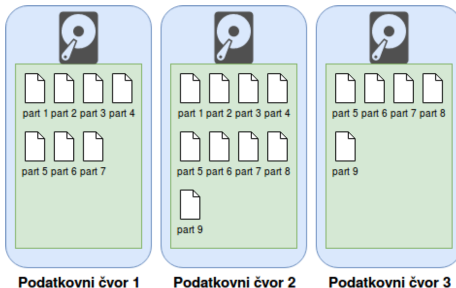
Slika 2.1. Podjela dijelova datoteke na više različitih čvorova u grozdu računala..
