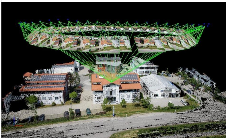
**Sl. 4.2.** Slika 3D zračnog mapiranja građevine [16]
