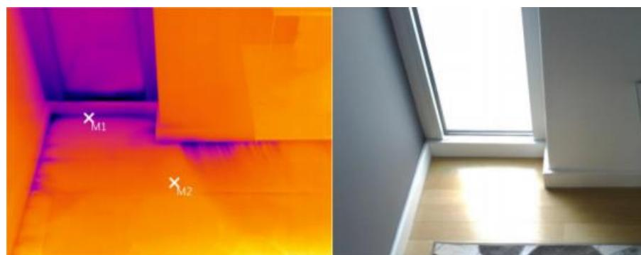
**Sl. 4.4. Termograf okova prozora sa propusnim spojnicama [17]**
