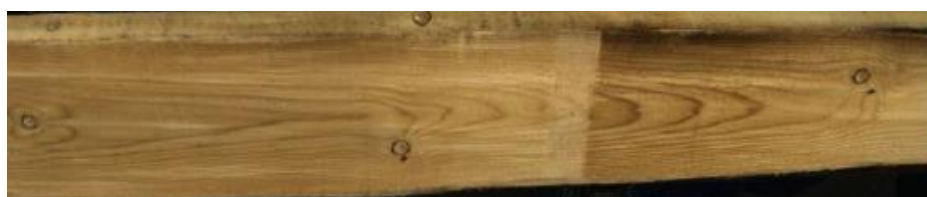
Sl. 4.2. Izgled vodene mrlje na drvetu.
