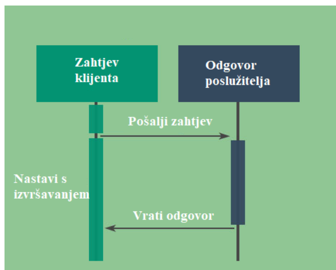
Slika 3.15. Asinkroni način izvršavanja koda u Node.js-u, prema [20]
