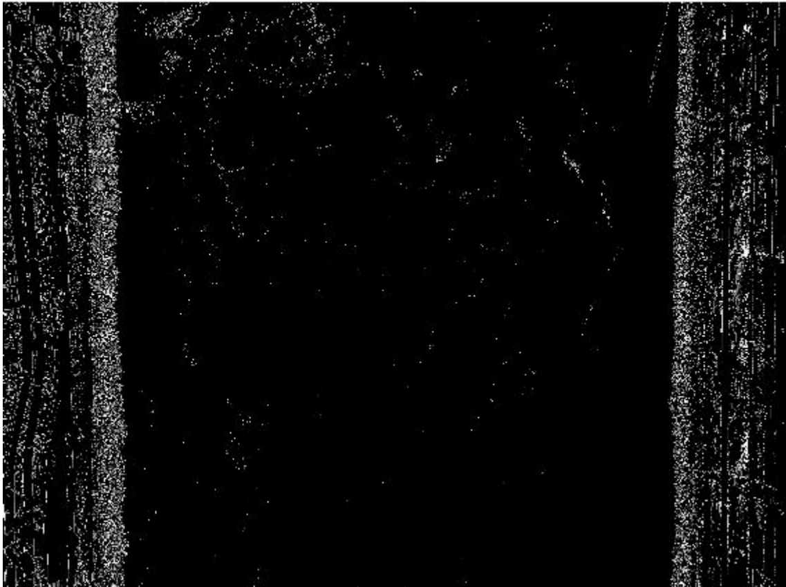
Sl. 3.9. Prikaz slike obradom funkcija cvtColor , blur i canny .
