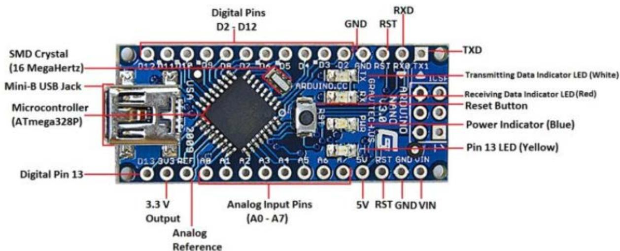
Slika 4.1. Arduino NANO pločica
