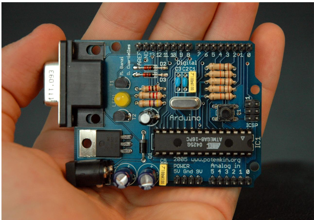
Sl 2.1. Prva pločica s Arduino natpisom, "Arduino Serial"
