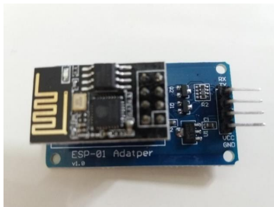
Slika 4.3. Bežični mrežni modul ESP8266 ESP-01 s adapterom
