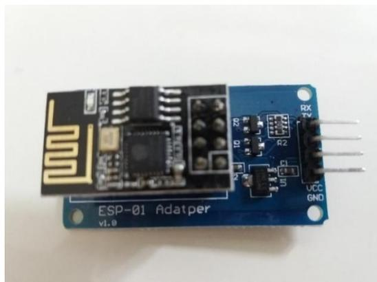
Slika 4.3. Bežični mrežni modul ESP8266 ESP-01 s adapterom
