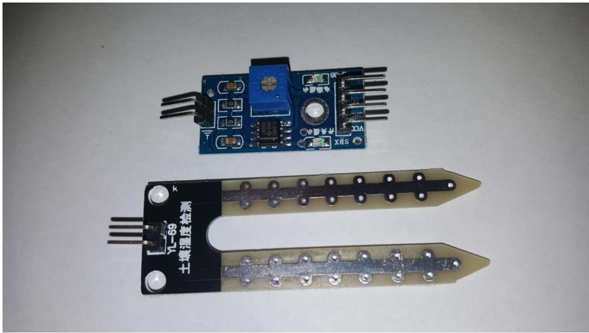
Sl. 2.7. Sonda i kontroler za vlagu tla.
