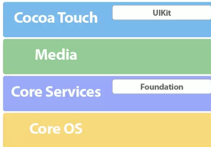
SI.3.7. Grafički prikaz arhitekturnih slojeva iOS operacijskog sustava [12]
