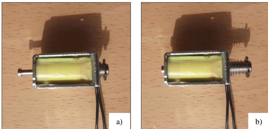
Slika. 4.2: a) Solenoid pod djelovanjem električne struje. b) Solenoid bez djelovanja električne struje.
