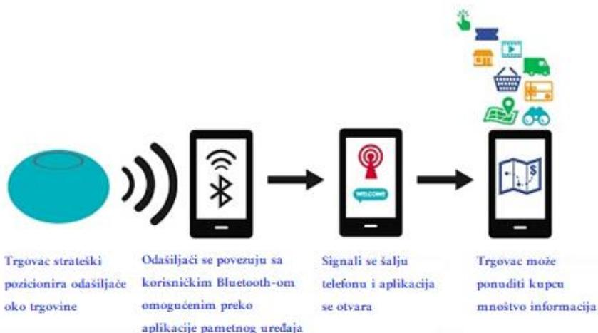
Slika 2.2. Princip rada Bluetooth tehnologije s odašiljačem, [4]
