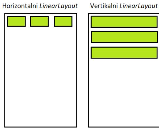
Slika 2.5. Horizontalni i vertikalni smjer *layout-a*, [11]
