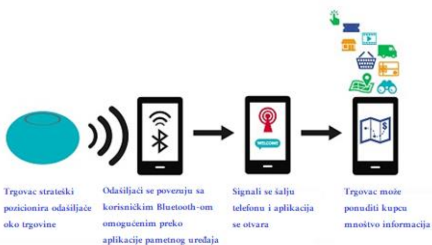
Slika 2.2. Princip rada Bluetooth tehnologije s odašiljačem, [4]
