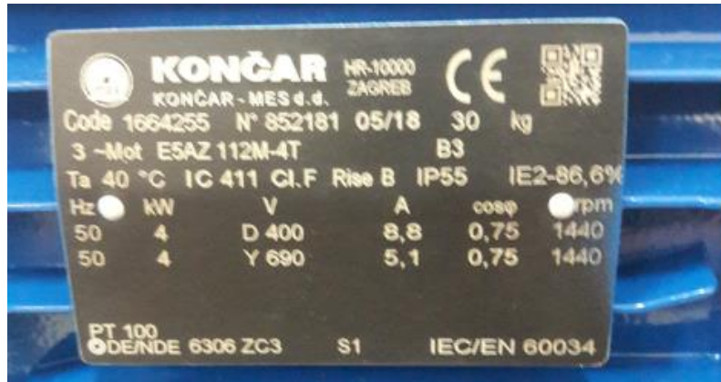
Slika 4.6. Natpisna pločica asinkronog motora
