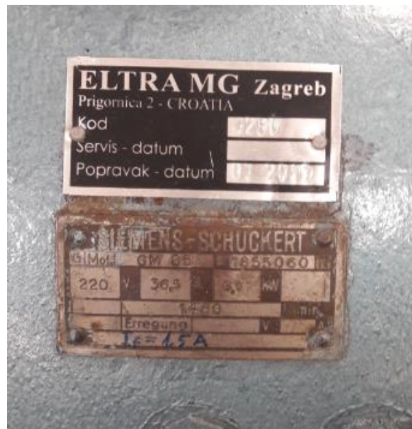
Slika 4.7. Natpisna pločica istosmjernog generatora
