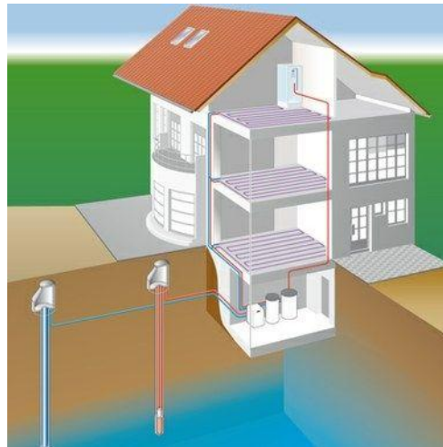
Slika 3.2. Sustav grijanja toplinske crpke voda/voda[6]
