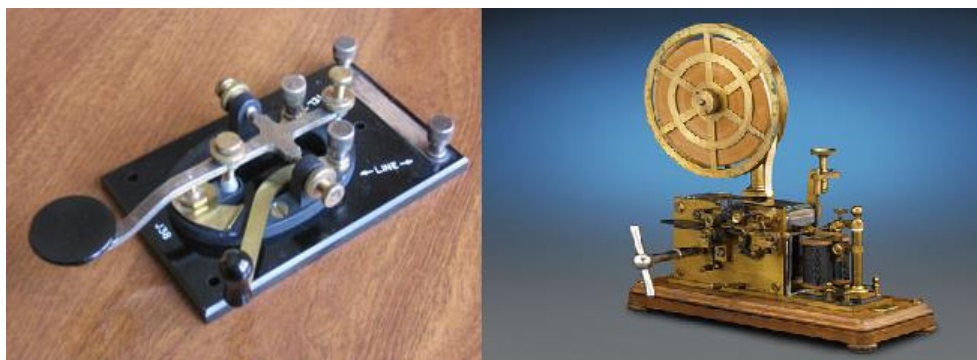
Sl. 2.2: Originalni Morseov koder i dekodeo.
