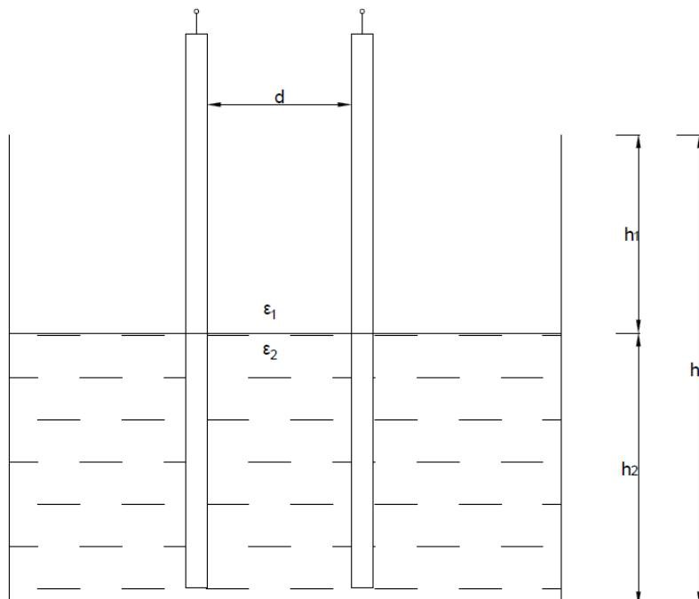
Sl. 2.19. Prikaz kapacitivnog načina mjerjenja razine tekućine [3]
