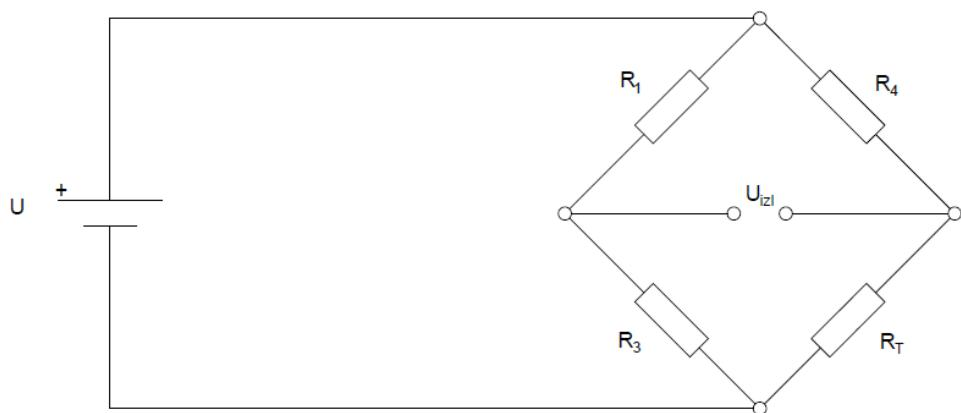
Sl. 2.4. Načelo mjerjenja temperature po promjeni električnog otpora
