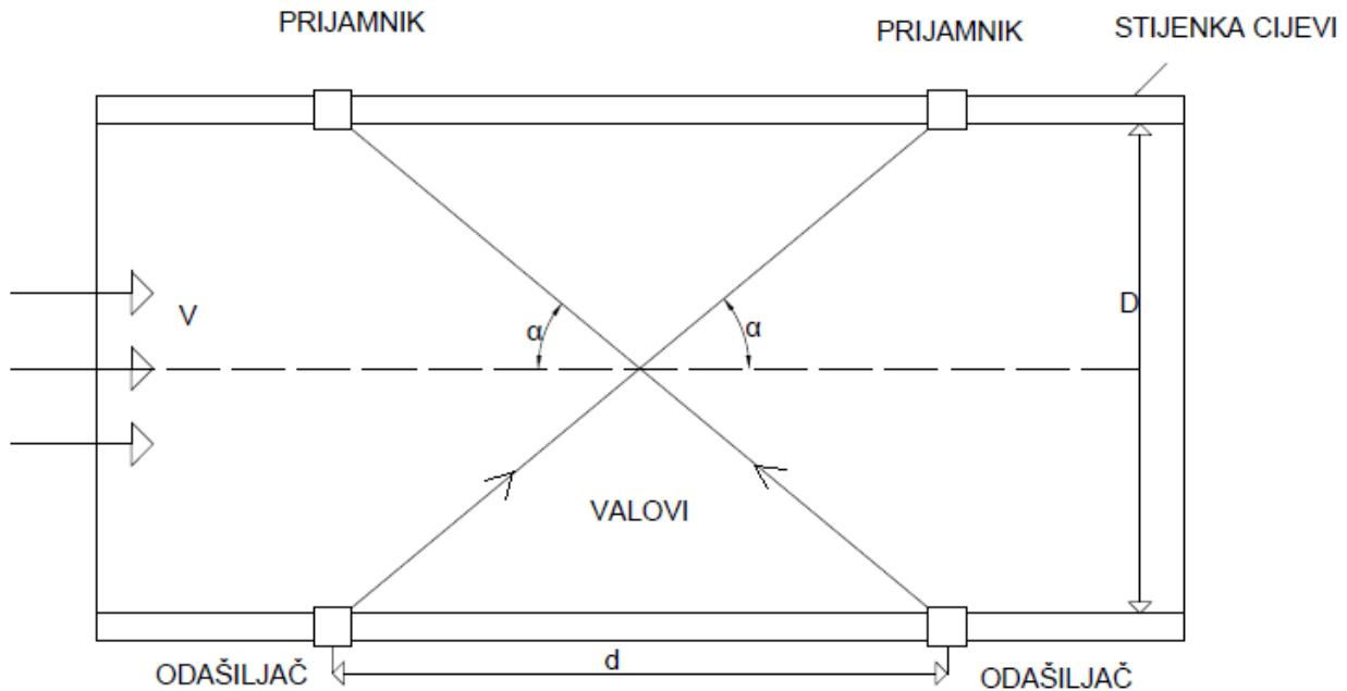
Sl. 2.14. Prikaz rada ultrazvučnog mjernog pretvarača protoka [3]
