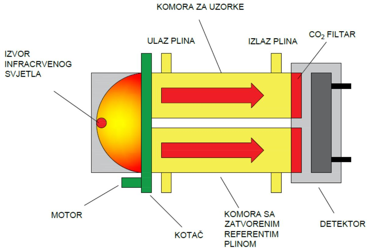
Sl. 2.29. – Princip rada infracrvenog senzora plina [24]
