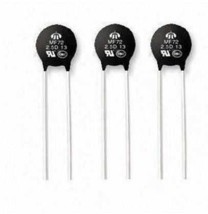
Sl. 2.3. Primjer temperaturno promjenjivih otpornika [7]
