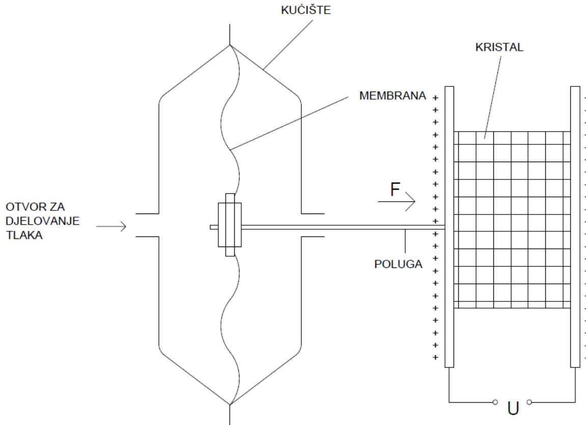
Sl. 2.13. Načelni prikaz piezoelektričnog pretvarača za mjerjenje tlaka [3]
