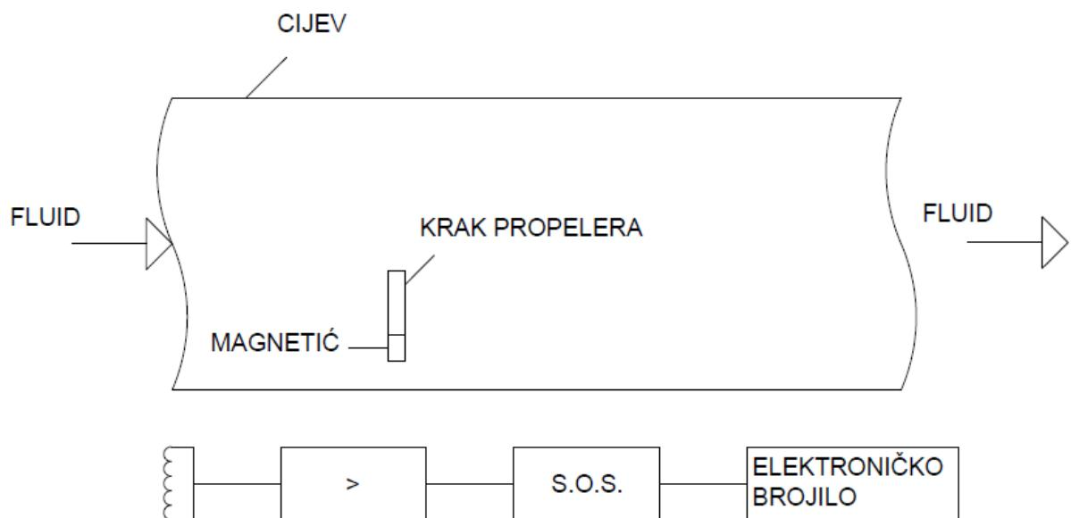
Sl. 2.15. Prikaz rada mjerjenja protoka s propelerom [3]
