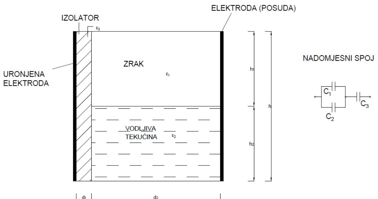
Sl. 2.20. Prikaz mjerjenja razine električki vodljive tekućine kapacitivnom metodom [3]
