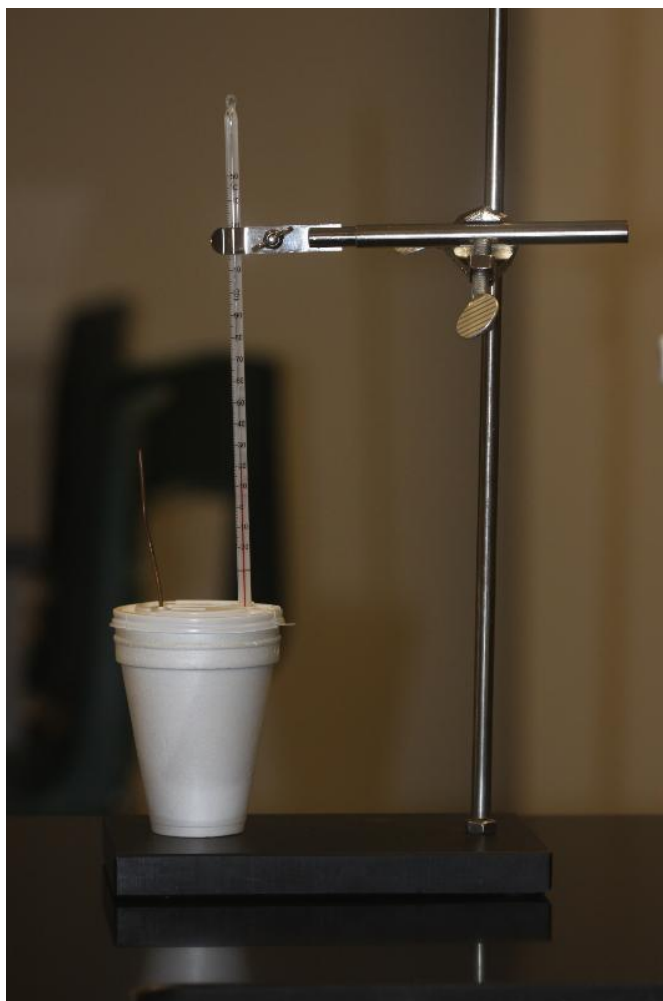
Sl. 2.27. – Prikaz praktičnog kalorimetra [22]
