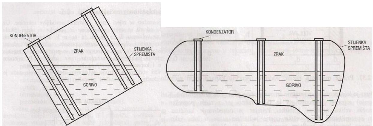
Sl. 2.21. Određivanje razine goriva u nagnutom zrakoplovu pomoću više osjetila i u spremištu nepravilnog oblika [3]
