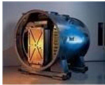
**Slika 2.5:** Gorivna čelija s rastaljenim karbonatima kao elektrolitom [2]
