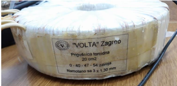
Slika 4.3. Torusna jezgra korištena za mjerenje
