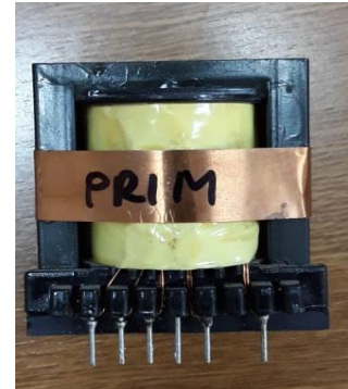
Slika 4.4. Feritna jezgra korištena za mjerenje
