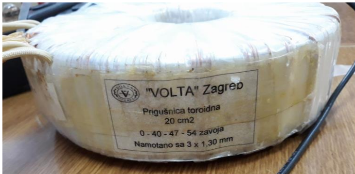
Slika 4.3. Torusna jezgra korištena za mjerenje
