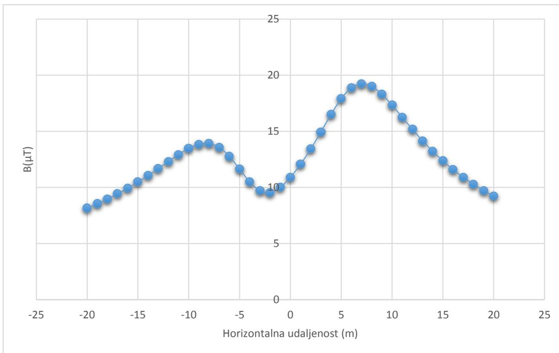
**Slika 4.23.** Prikaz ukupne magnetske indukcije za gama glavu stupa protjecanog nesimetričnim strujama nazivnog napona 400 kV
