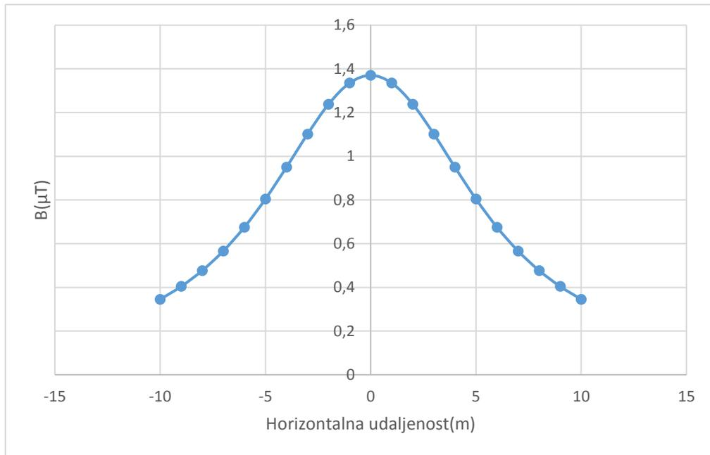
*Slika 4.11. Prikaz ukupne magnetske indukcije za gama glavu stupa nazivnog napona 20 kV
