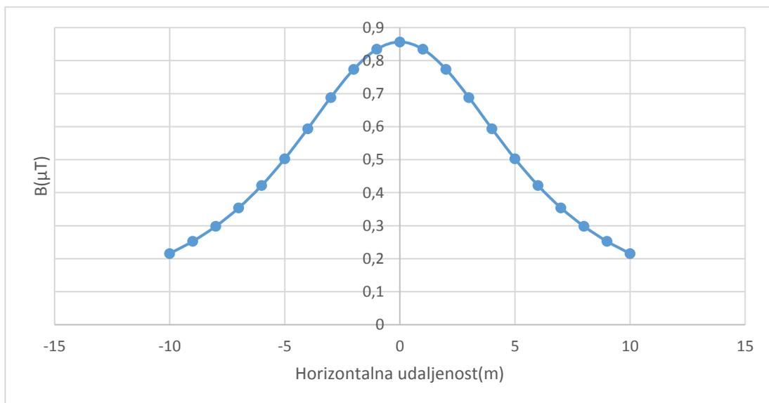
*Slika 4.10. Prikaz ukupne magnetske indukcije za gama glavu stupa nazivnog napona 20 kV
