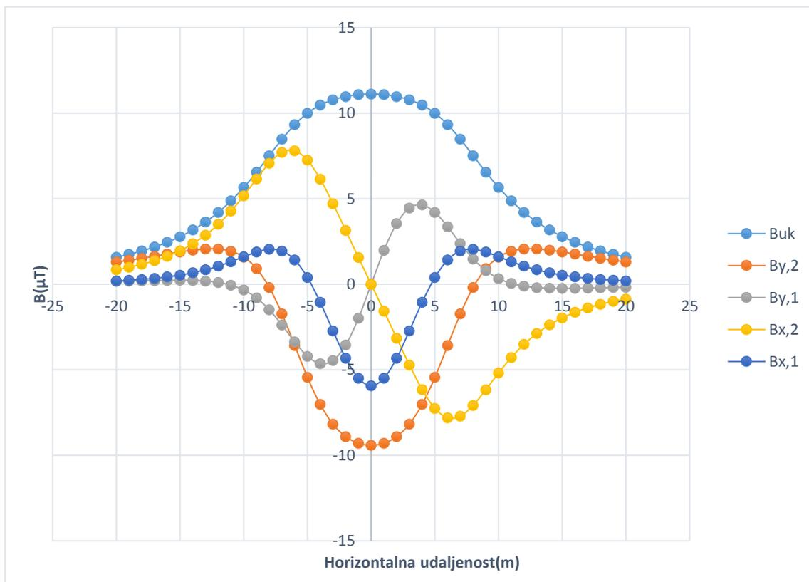
*Slika 4.19. Prikaz komponenti i ukupne magnetske indukcije za gama glavu stupa nazivnog napona 400 kV,  $I = 300 A$*
