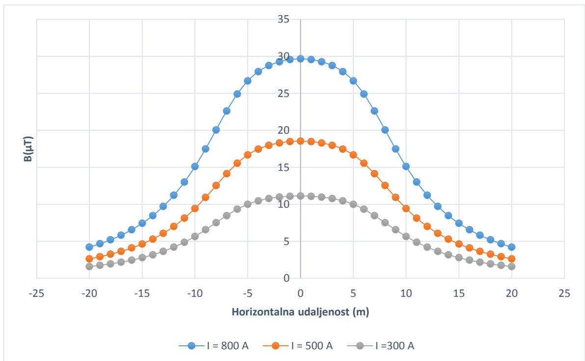
*Slika 4.22. Prikaz ukupne magnetske indukcije za gama glavu stupa nazivnog napona 400 kV*
