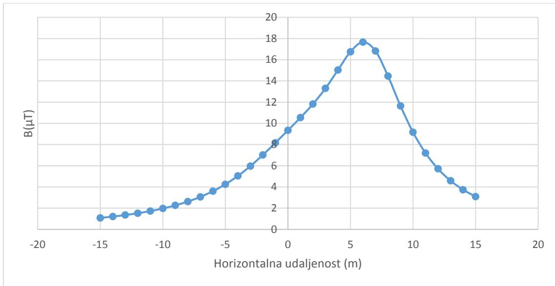
*Slika 4.16. Prikaz ukupne magnetske indukcije za glavu stupa jela nazivnog napona 110 kV
