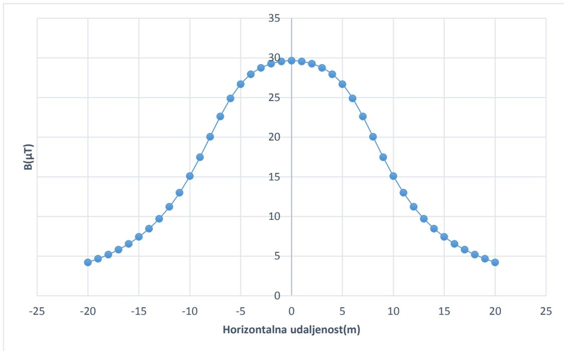
*Slika 4.21. Prikaz ukupne magnetske indukcije za gama glavu stupa nazivnog napona 400 kV
