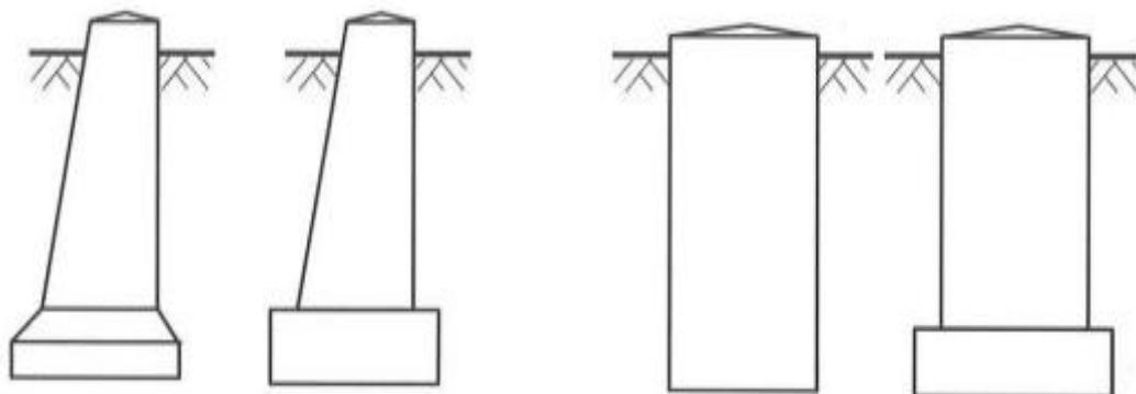
*Slika 2.4. Oblici temelja za stup nadzemnog voda [1]*
