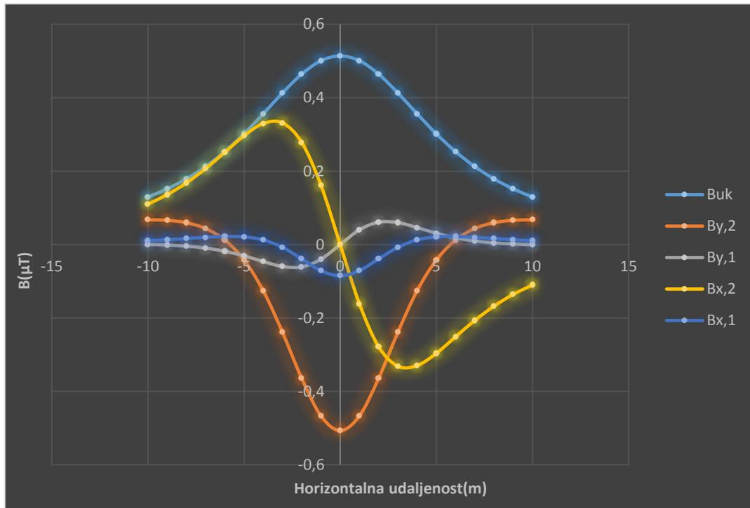
*Slika 4.9. Prikaz komponenti i ukupne magnetske indukcije za gama glavu stupa nazivnog napona 20 kV,
