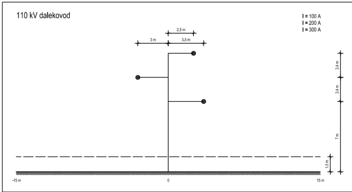
*Slika 4.13. Raspored vodiča stupa glave jela, 110 kV*
