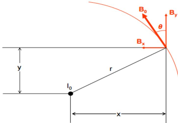
*Slika 4.3. Vertikalna i horizontalna komponenta magnetske indukcije [6]*
