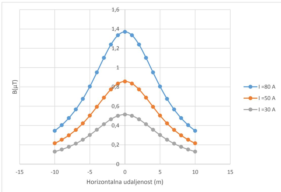
*Slika 4.12. Prikaz ukupne magnetske indukcije za gama glavu stupa nazivnog napona 20 kV*
