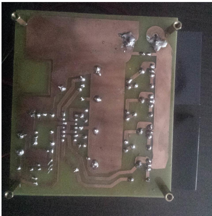
Sl. 5.4. Donja strana tiskane pločice gotovog sklopa
