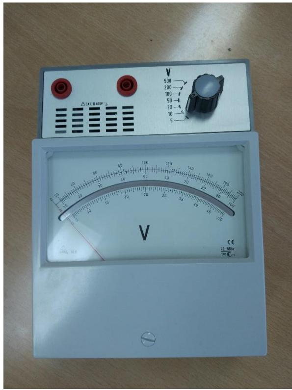
S1.2.14. Instrument s pomičnim željezom SIEMENS
