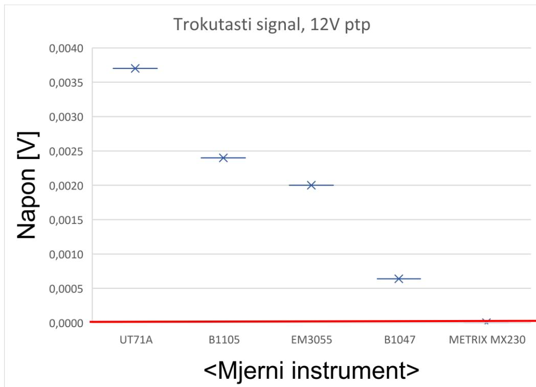
Sl. 3.9. Pokazivanje mjernih instrumenata za trokutasti signal, 12V ptp
