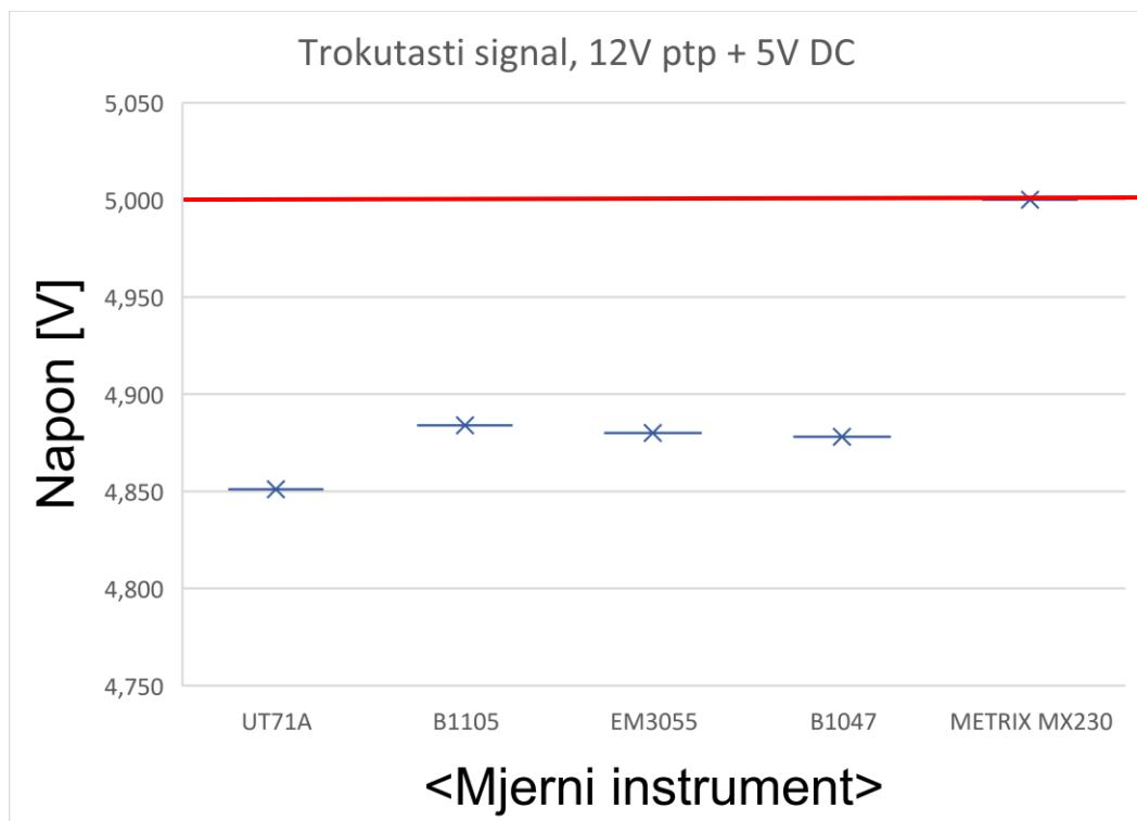
Sl. 3.10. Pokazivanje mjernih instrumenata za trokutasti signal, 12V ptp + 5V DC
