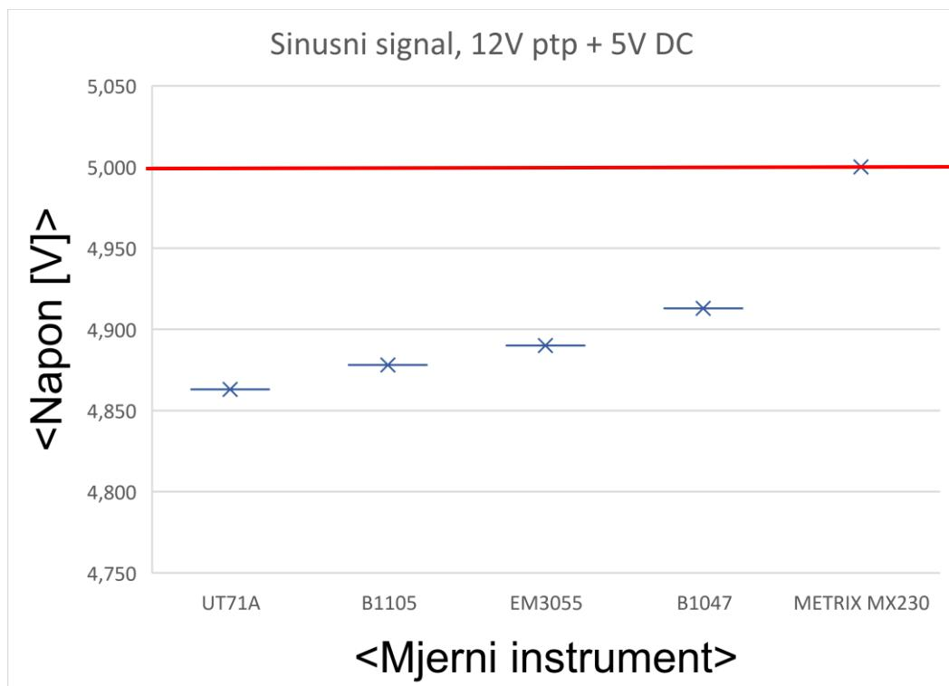
Sl. 3.8. Pokazivanje mjernih instrumenata za sinusni signal, 12V ptp + 5V DC
