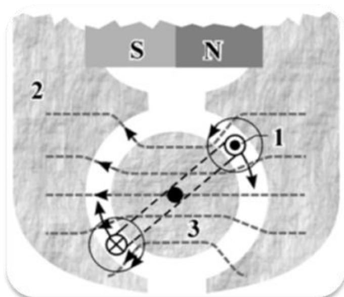
Slika 2.1. Instrument s pomičnim svitkom i permanentnim magnetom
