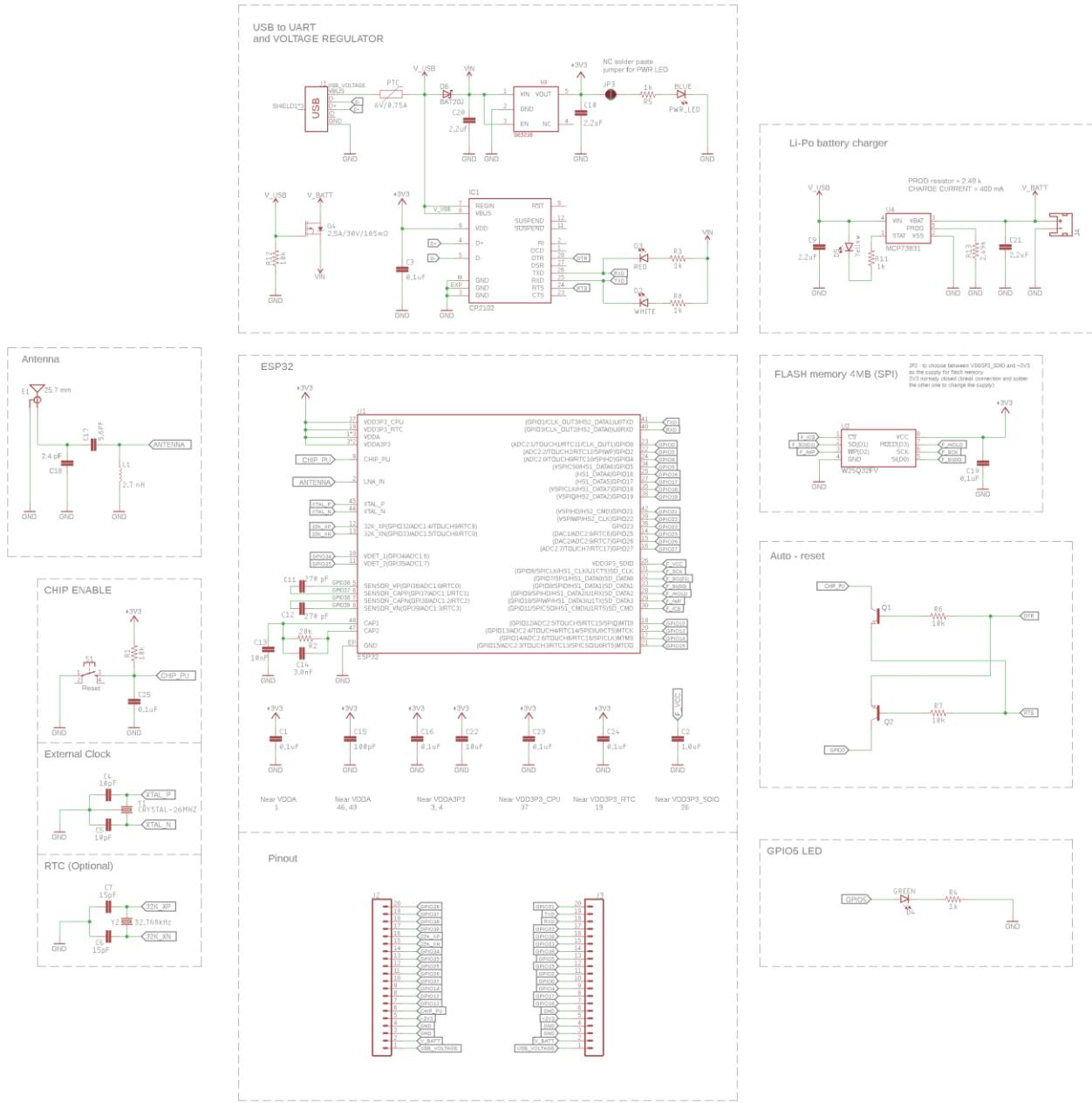
*Sl. 3.1. Električka shema ESP32 razvojne pločice*
