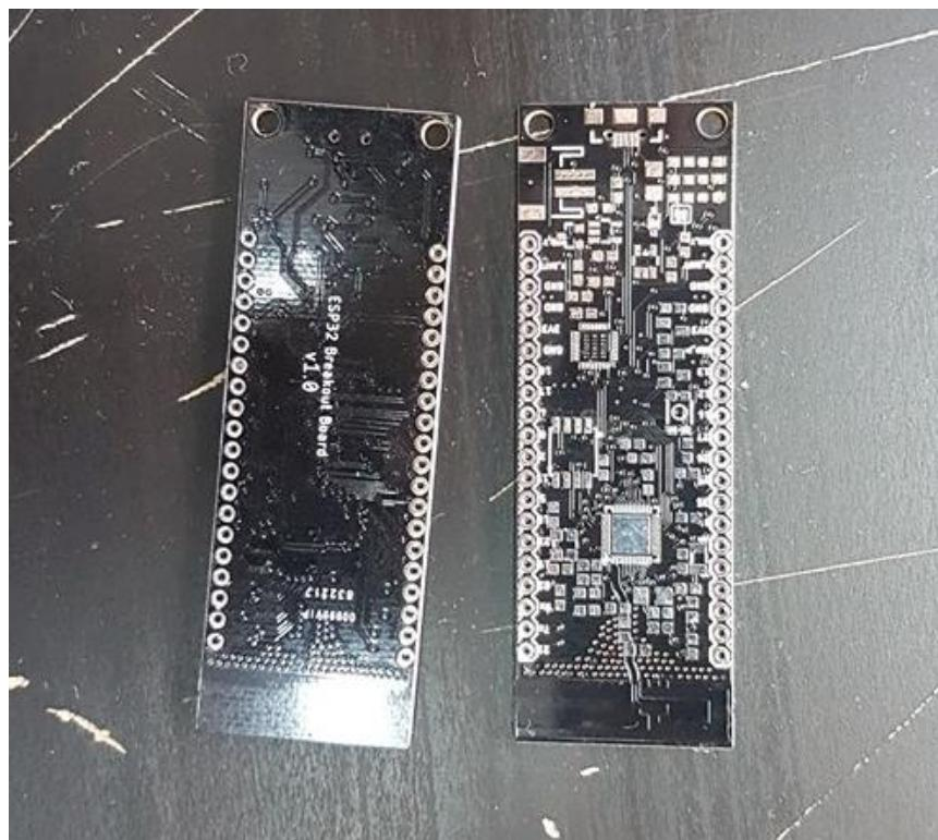
*Sl. 3.3. ESP32 razvojna pločica nakon proizvodnje (bez zalemlijenih komponenti)*
