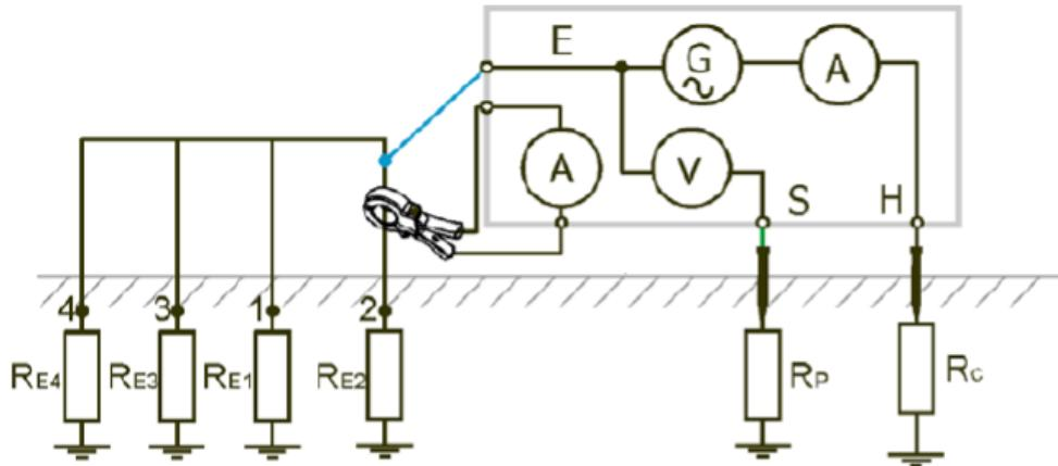
Slika 4.8. Shema mjerena strujnim kliještima[13]
