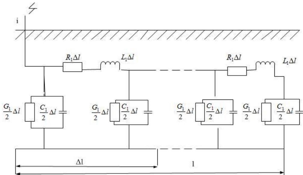
Slika 3.1 lanac  $\pi$  shema koji se sastoji od  $R_I, G_I, L_I, C_I$  [1]
