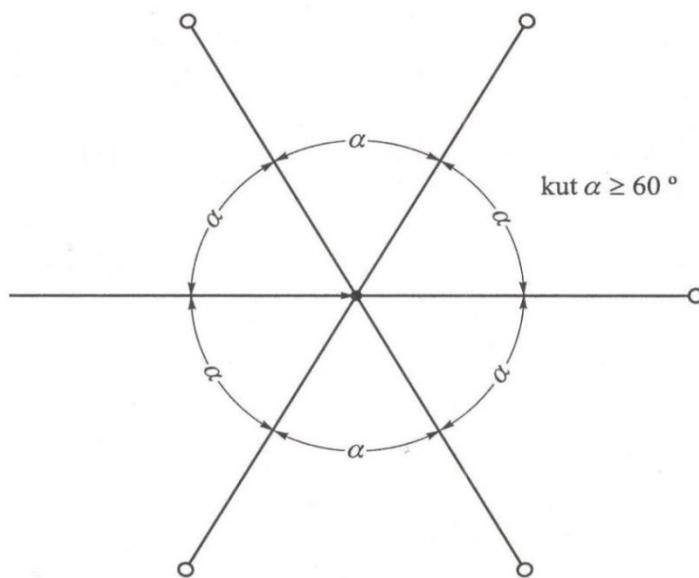
Slika 2.8 Zrakasti uzemljivač [1]
