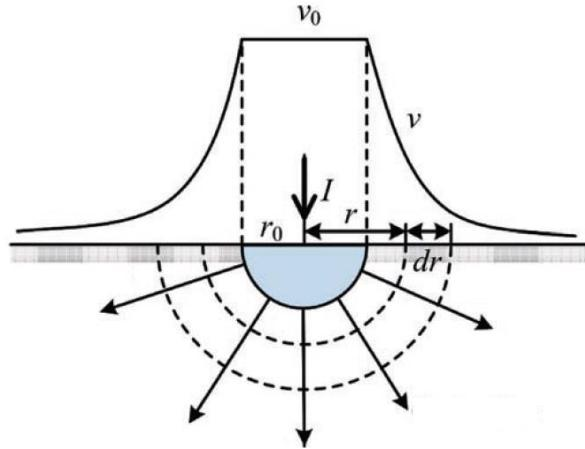
Slika 2.12 Polukuglasti uzemljivač[5]
