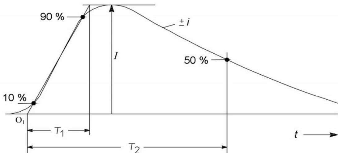
$O_1$  = virtualni početak,  $I$  = vršna jakost struje,  $T_1$  = trajanje čela,  $T_2$  = poluvrijeme hrpta udarnog vala
