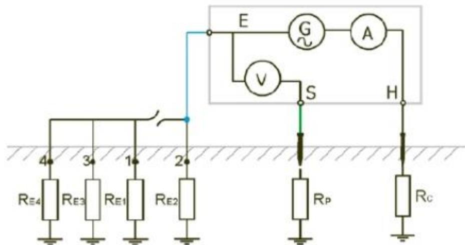
Slika 4.7. Shema mjerjenja otpora jednog uzemljivača[13]
