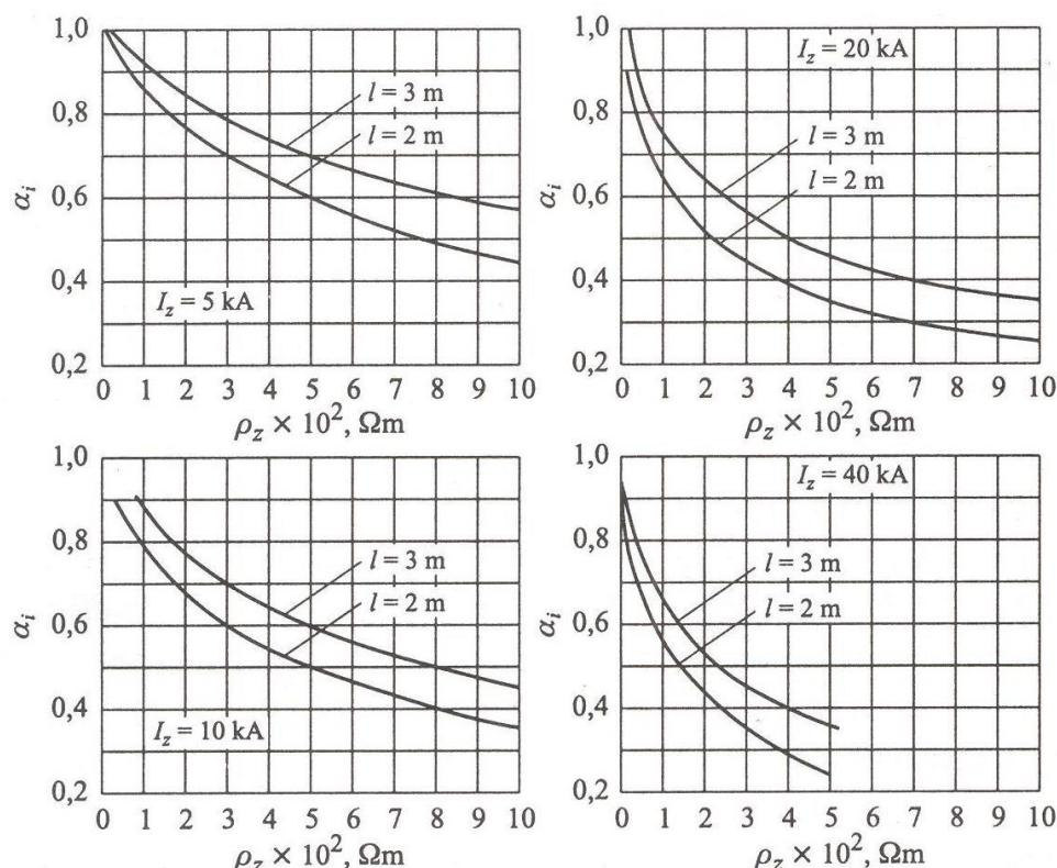
Slika 3.7 Dijagrami impulsnog koeficijenta za štapni uzemljivač [1]
