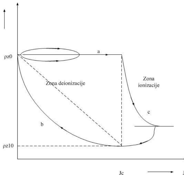
Slika 3.5 Otpornost tla u ovisnosti o gustoći struje [1]
