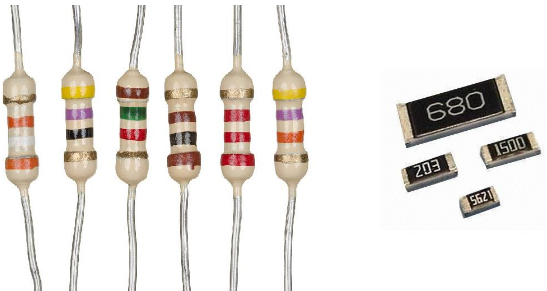
Slika 2.4. Thru-hole i smd otpornici [11]
