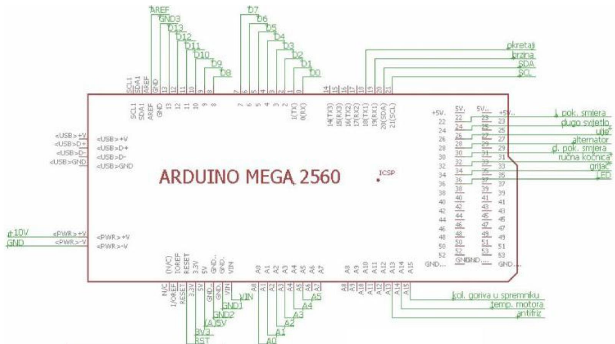
Slika 4.23. – Prikaz sheme spajanja Arduina [10]
