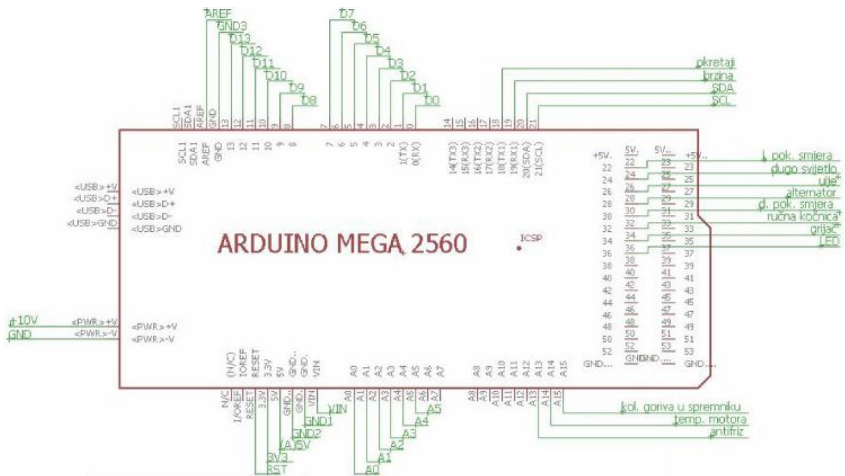
Slika 4.23. – Prikaz sheme spajanja Arduina [10]
