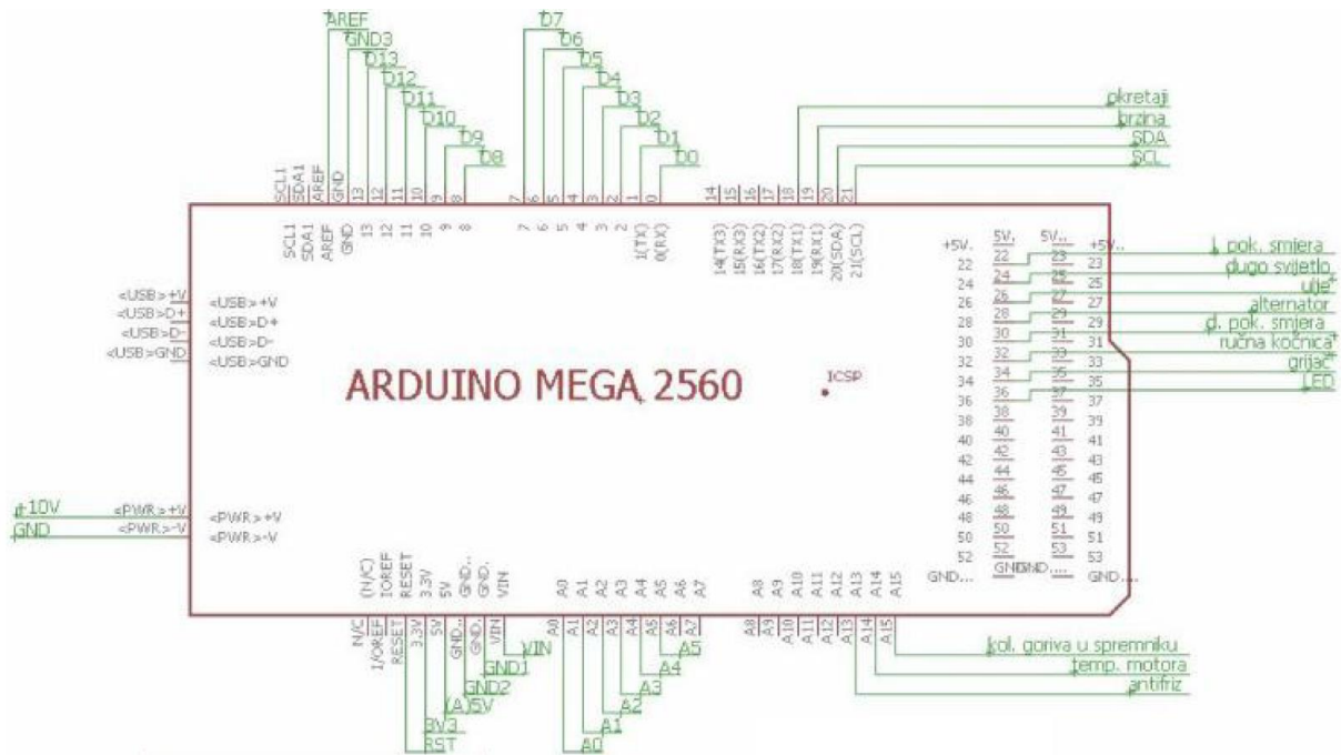
Slika 4.23. – Prikaz sheme spajanja Arduina [10]
