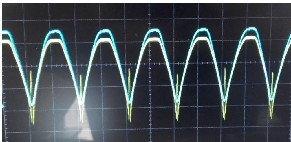
Slika 3.11 Valni oblik za napon 15 V i struju 4 A
