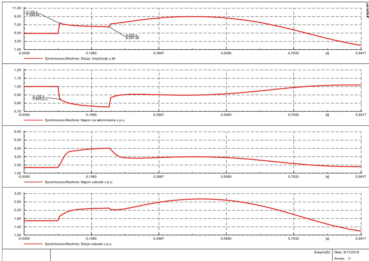
**Slika 3.9.** Kratki spoj na 99% udaljenosti sa sustavom uzbude
