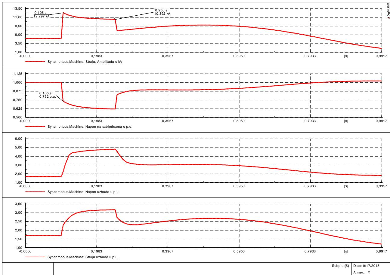
**Slika 3.7.** Kratki spoj na 50% udaljenosti sa sustavom uzbude
