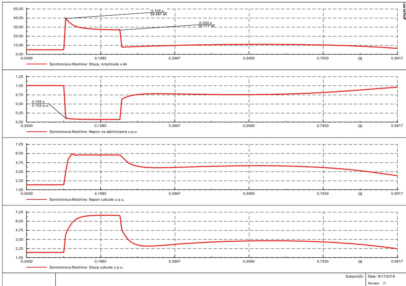
**Slika 3.5.** Kratki spoj na 0.1% udaljenosti s sustavom uzbude
