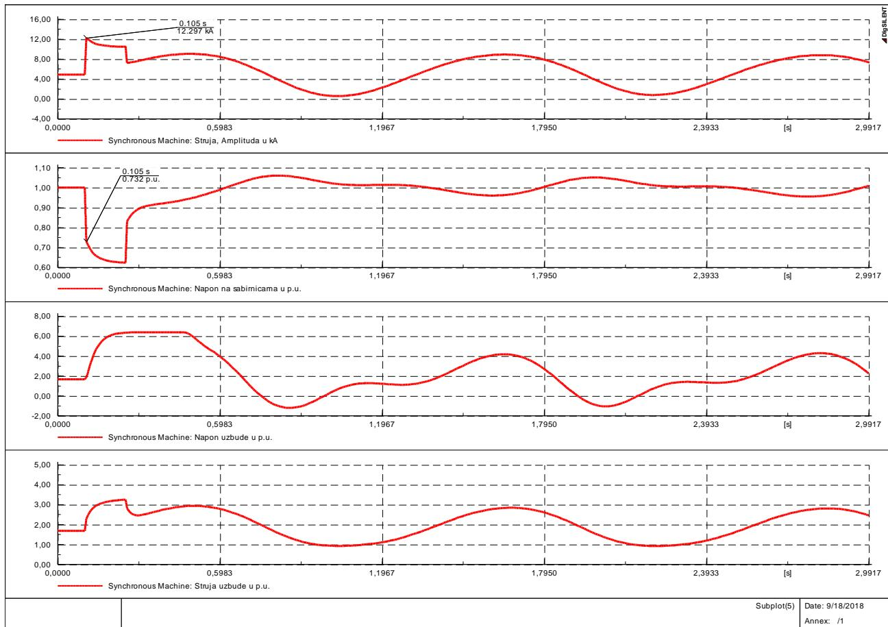
**Slika 3.11.** Kratki spoj na 50 % udaljenosti
