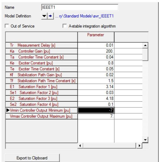
Slika 3.10. Izmjenjeni parametri sustava
