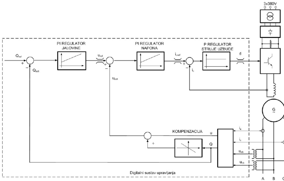
Slika 2.17. Regulacijska struktura sinkronog generatora spojenog na EES[1]
