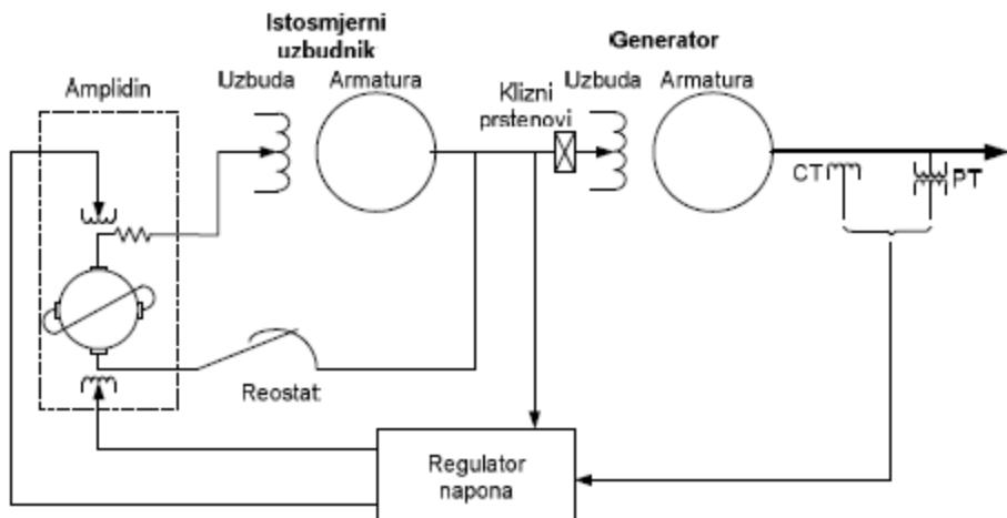
**Slika 2.2.** Prikaz sustava istosmjerne rotacijske uzbzde[1]
