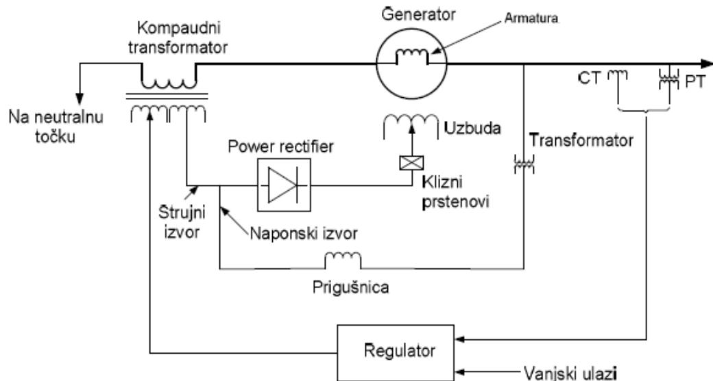
**Slika 2.11.** Sustav statičke uzbude s kompaundirajućim namotom[1]
