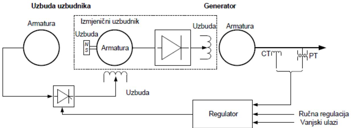
**Slika 2.5.** Sustav uzbude s izmjeničnom rotacijskom uzbudom s rotirajućim diodama[1]
