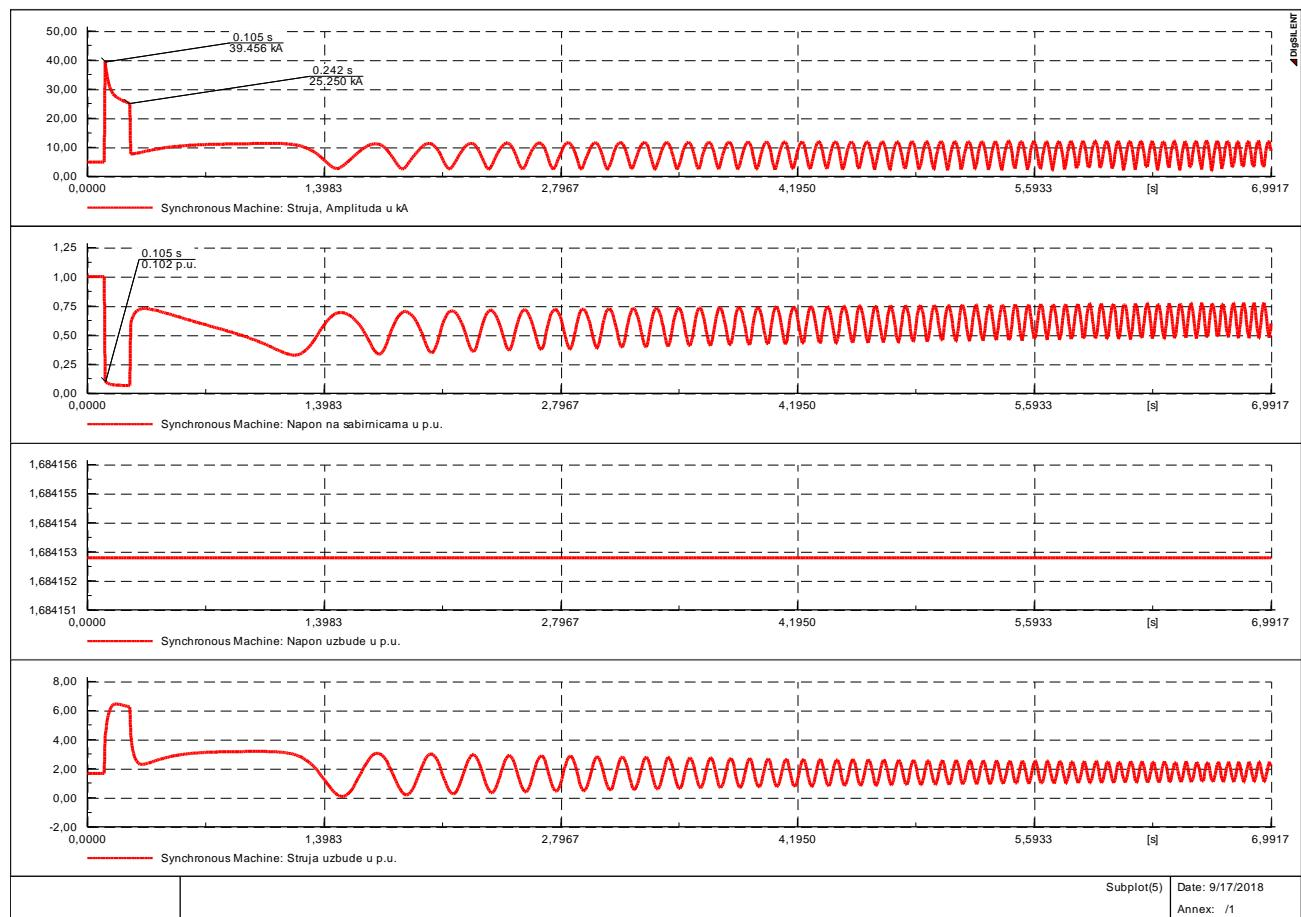
**Slika 3.4.** Kratki spoj na 0,1% udaljenosti bez sustava uzbude
