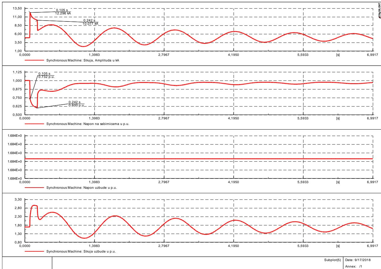
**Slika 3.6.** Kratki spoj na 50% udaljenosti bez sustava uzbude
