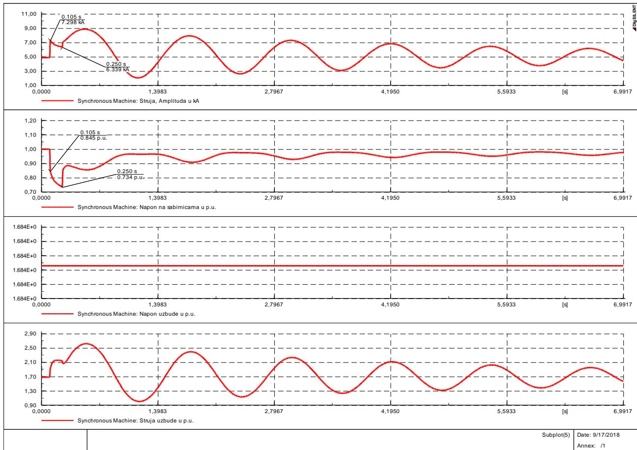
**Slika 3.8.** Kratki spoj na 99% udaljenosti bez sustava uzbude
