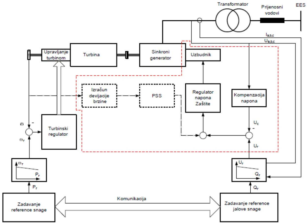
Slika 2.18. Struktura upravljanja sinkronim generatorom[1]
