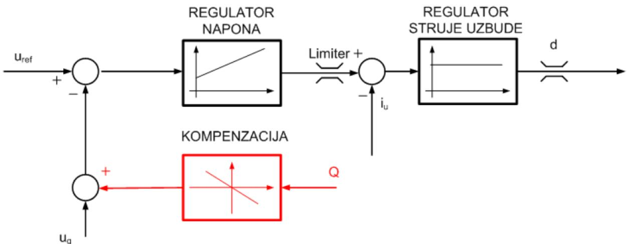
**Slika 2.16.** Regulacijska struktura s kompenzacijom jalove snage[1]
