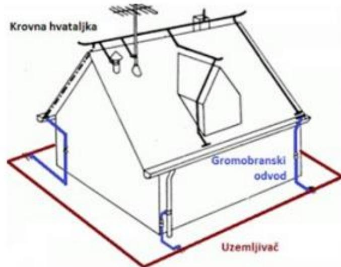
Slika 2.3. Gromobransko uzemljenje [1]
