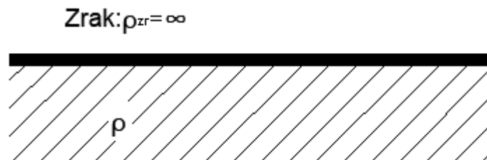
Slika 4.1. Model jednoslojnog tla [2]
