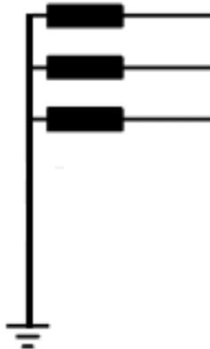
Slika 2.1. Pogonsko uzemljenje zvjezdišta transformatora [1]
