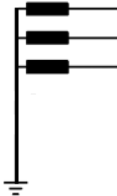
Slika 2.1. Pogonsko uzemljenje zvjezdišta transformatora [1]
