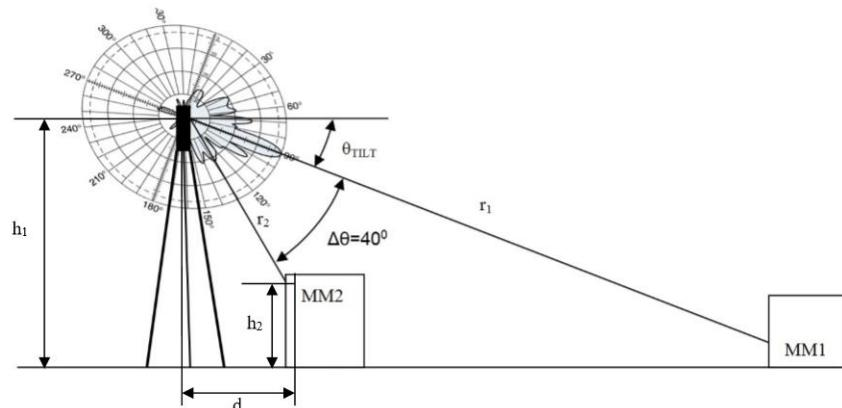
**Sl. 3.10.** Geometrijska slika mjernog mesta i izvora zračenja sa označenim: visinom izvora zračenja  $h_1$ , visinom mjernog mesta (MM2)  $h_2$ , tlocrtnom udaljenosti mjernog mesta (MM2)  $d$  te udaljenosti mjernog mesta MM1 i MM2:  $r_1$  i  $r_2$  [1]
