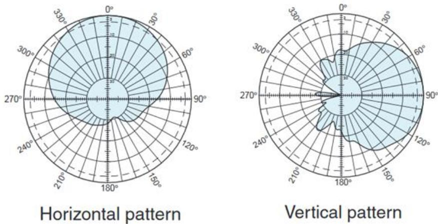
**Sl. 3.4.** Horizontalni (lijevo) i vertikalni (desno) dijagram zračenja antene Kathrein 840 10535 [9]
