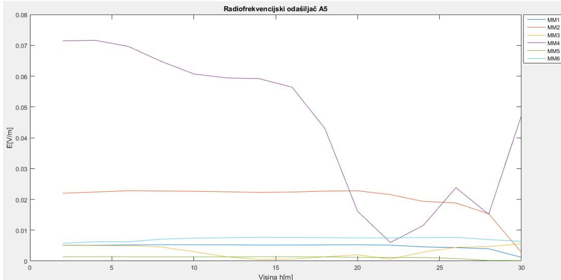
Sl. 4.8. Grafički prikaz rezultata mjerena za radiofrekvenčnog odašiljača A5
