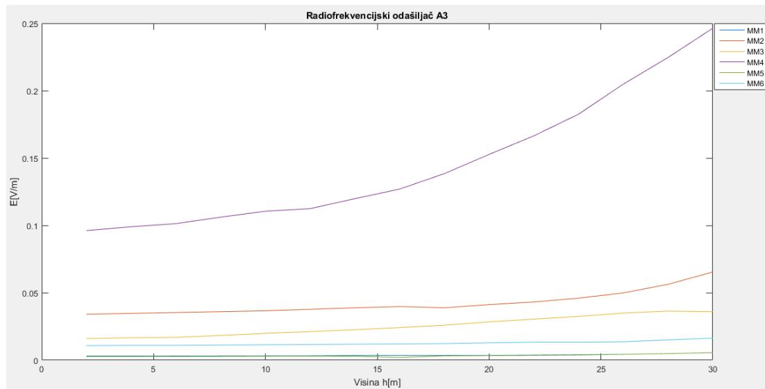
**Sl. 4.6.** Grafički prikaz rezultata mjerjenja za radiofrekvenčni odašiljač A3
