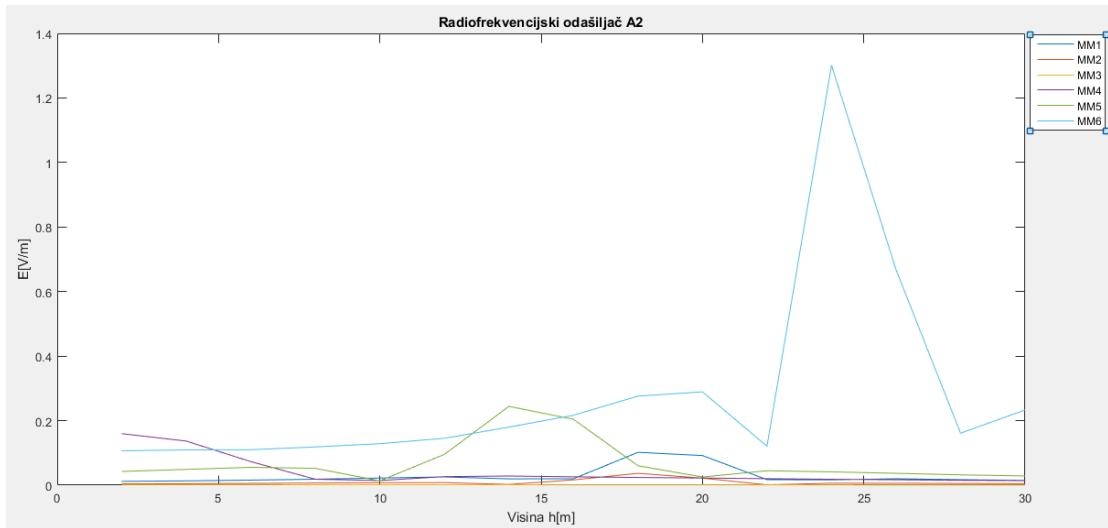
**Sl. 4.5.** Grafički prikaz rezultata mjerena za radiofrekvenčni odašiljač A2
