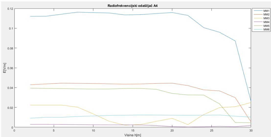
**Sl. 4.7.** Grafički prikaz rezultata mjerena za radiofrekvenčni odašiljač A4
