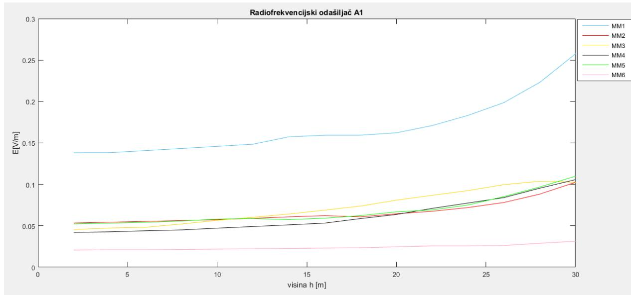
**Sl. 4.4.** Grafički prikaz rezultata mjerena za radiofrekvenčni odašiljač A1
