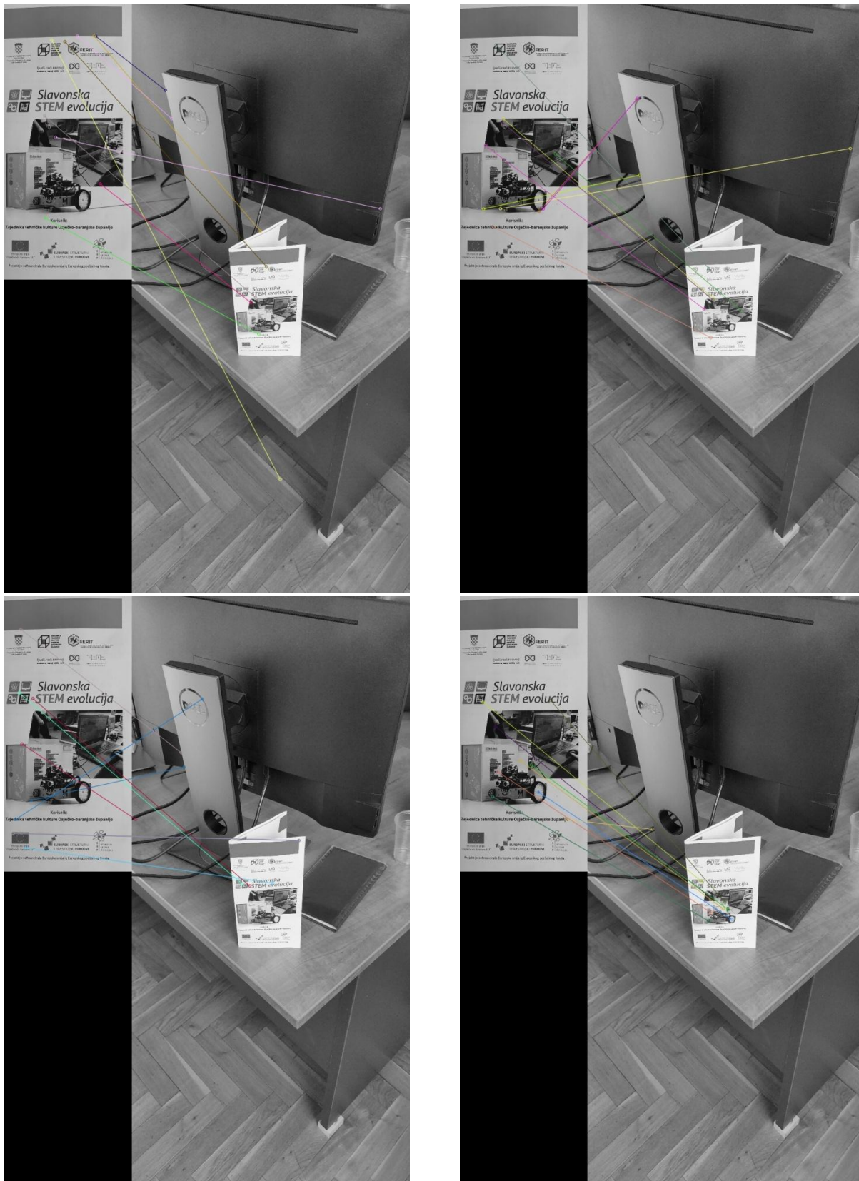
Slika 4.13. Rezultati na slici: gore lijevo FREAK, gore desno BRISK, dolje lijevo SIFT, dolje desno SURF
